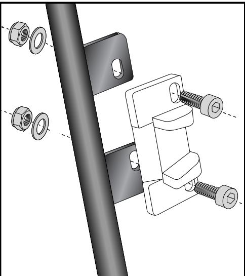
Montage des Metalladapters zum Einhaken des Kofferhalteschlusses
