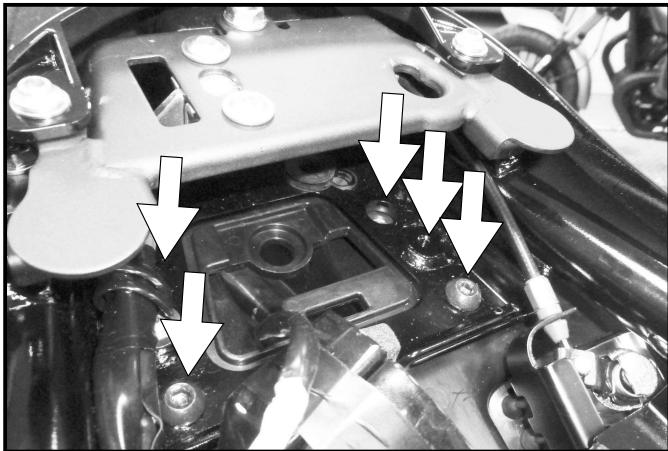
Nun die Blinker lösen und durch das Heck entnehmen, diese werden an den Blinkerhalter wie original befestigt.
