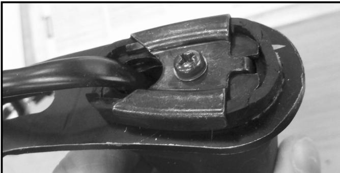
Nun den originalen Reflektorenhalter durch den mitgelieferten Halteadapter oben hinten ersetzen und diesen samt Kennzeichenhalter wieder verschrauben.
