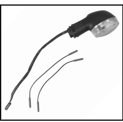
Die Sitzbank sowie die darunterliegende Schlosstraverse (Abb.1) demontieren, Blinkerstecker(Abb.3) lösen.
