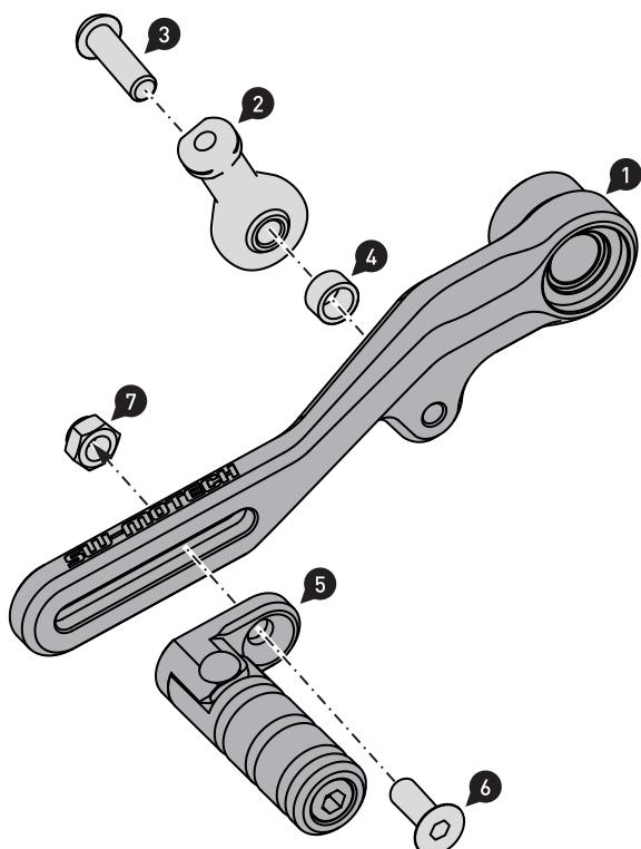
Verschrauben Sie die gezeigten Teile am Schalthebel (1), wie in der Zeichnung gezeigt. Ziehen Sie die Schraube (6) noch nicht an.
