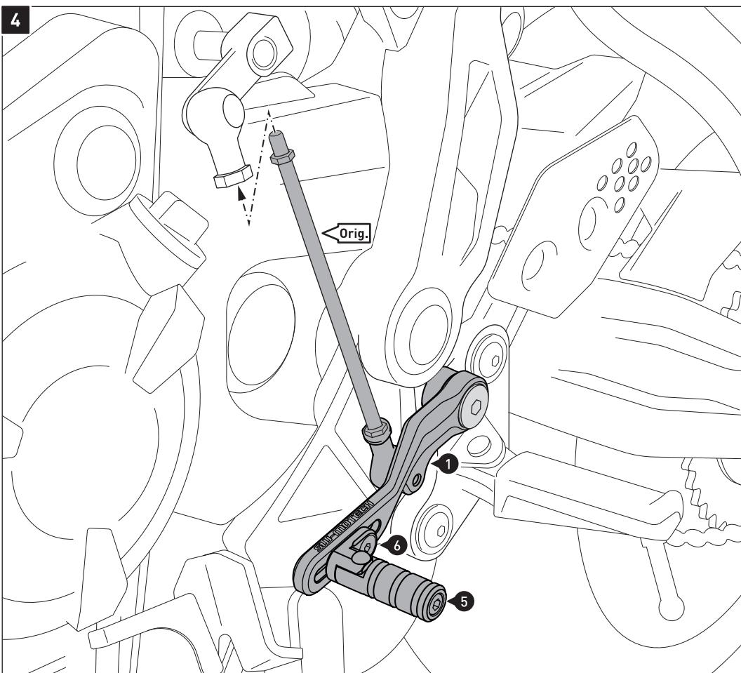
Verschrauben Sie die originale Umlenkstange (Orig.) mit dem Schalthebel (1) und am Fahrzeug (**min. 6 Gewindegänge**); kontern Sie die Gewinde mit den Muttern.
