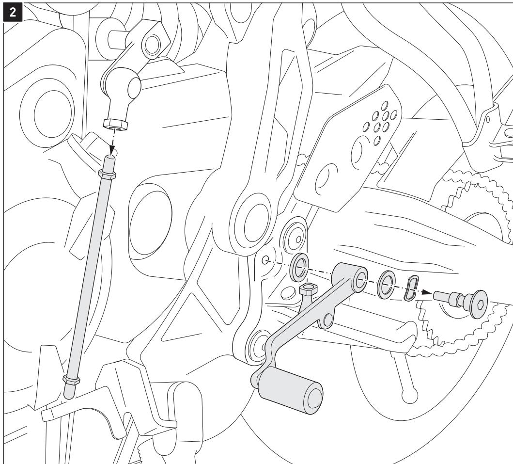
Lösen Sie die Schrauben und Umlenkstange vom originalen Schalthebel und entfernen Sie diesen vom Fahrzeug.
