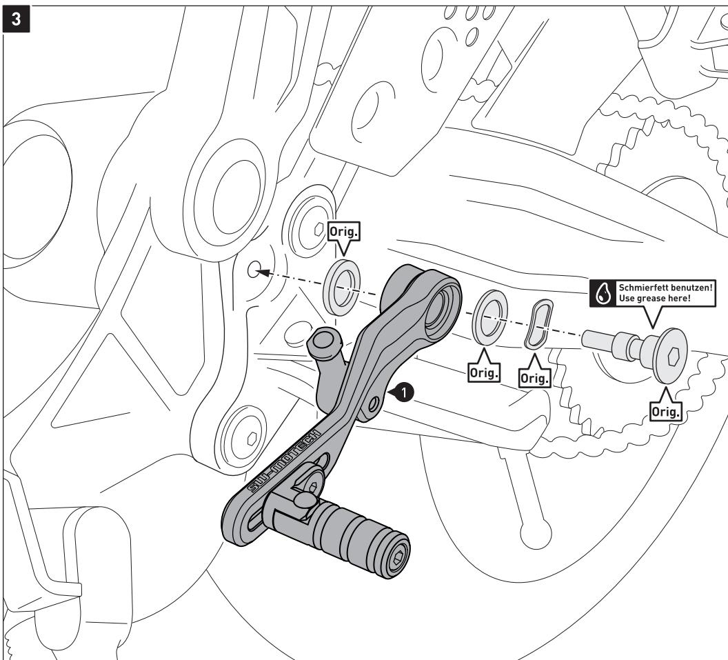
Verschrauben Sie den Schalthebel (1) mit der originalen Schraube und Dichtungsringen (Orig.) am Fahrzeug.
