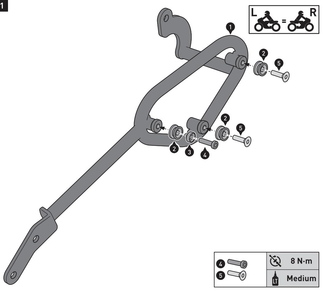
**HINWEIS:** Die Montageschritte [1] bis [3] zeigen die Montage des linken Seitenträgers. Die Montage des rechten Seitenträgers erfolgt analog zur linken Fahrzeugseite.
