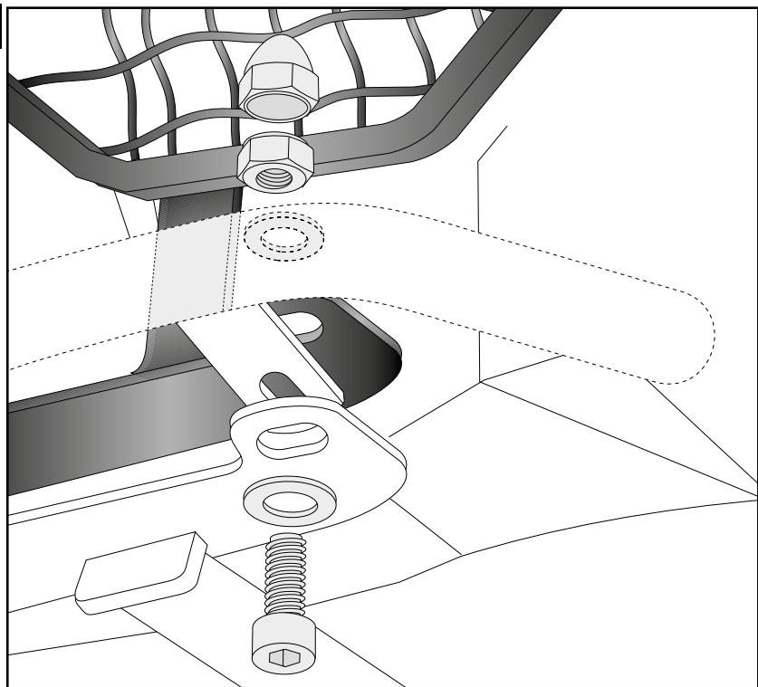
**Montage des Lampengitters ohne Tankschutzbügel:
