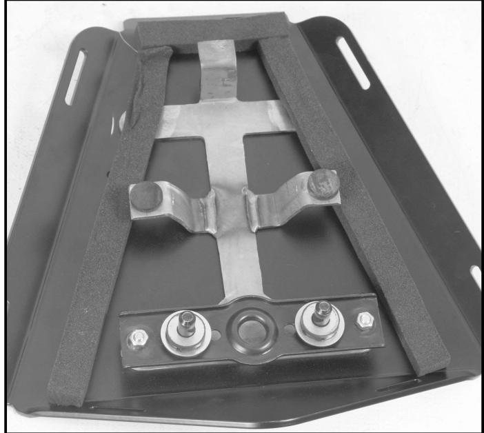
Wenn das Sporttrack nach dem Einrasten im Schloss zu viel Spiel hat (Klappergeräusche beim Fahren), können unter die Gummidämpfer der Schlossplatte (Suzuki Originalteil) noch die 2 x Karosseriescheiben ø10,5 x ø30 gefügt werden.
