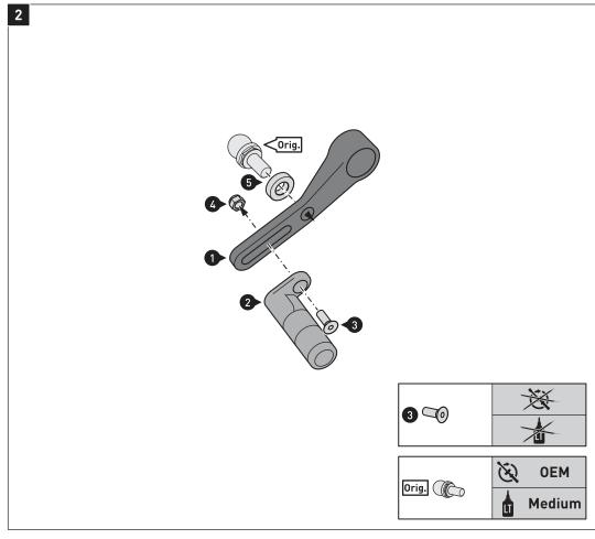
Verschrauben Sie die gezeigten Teile am Schalthebel (1), wie in der Zeichnung gezeigt. Ziehen Sie die Schraube (3) noch nicht an.
