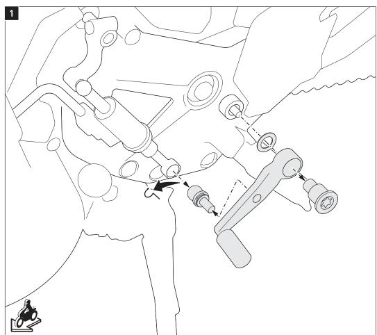
Entfernen Sie den Sicherungsstift vom original Schalthebel.
