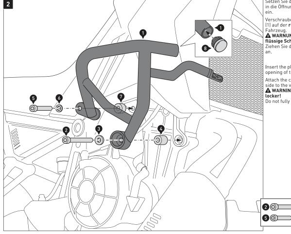
Setzen Sie den Kunststoffstopfen (8) in die Öffnung des Sturzbüges (1) ein
