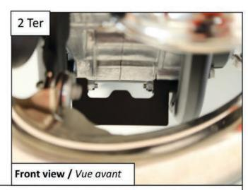
Place the front plastic fixation as shown / Placer la fixation avant suivant les photos : 2 Tchc 6x45mm + 4 M6
