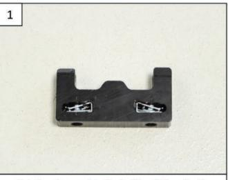
Put the clamped bolts inside of the plastic block / Insérer les écrous pinces
