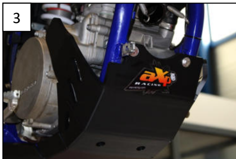
Fit the front using Th6x25mm Fixer l'avant a l'aide des Th6x25mm
