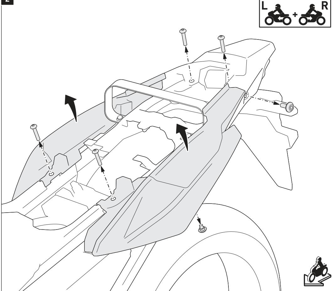
Entfernen Sie beidseitig die gezeigten Schrauben und anschließend die hinteren Seitenverkleidungen vom Fahrzeug. Achten Sie dabei auf die Kunststoffhaken der Seitenverkleidungen.
