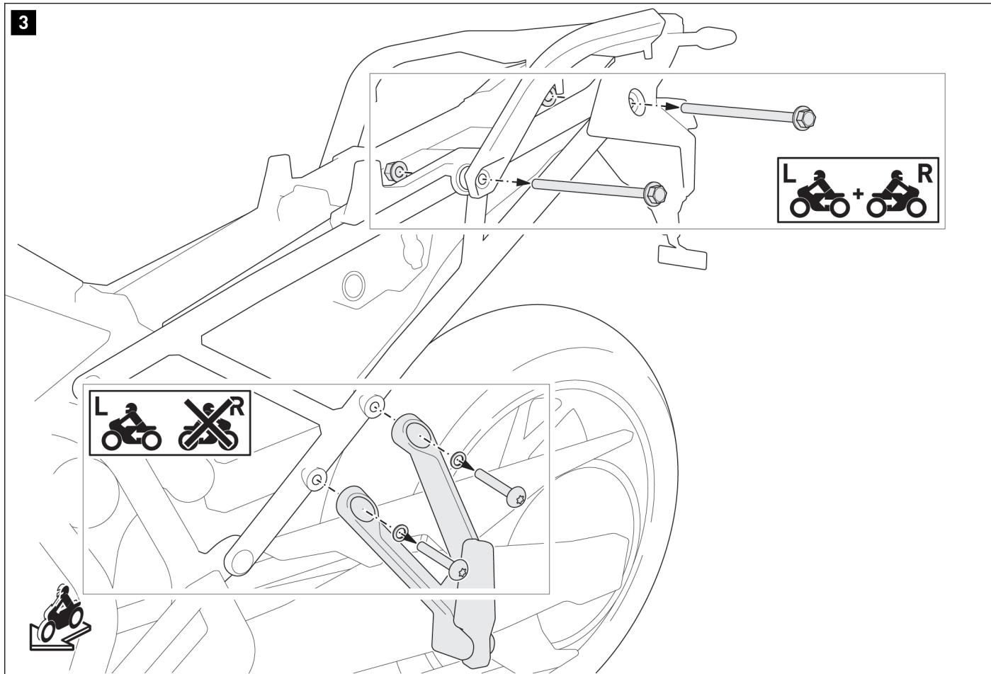
Entfernen Sie die gezeigten Schrauben und Muttern beidseitig vom Fahrzeugheck.
