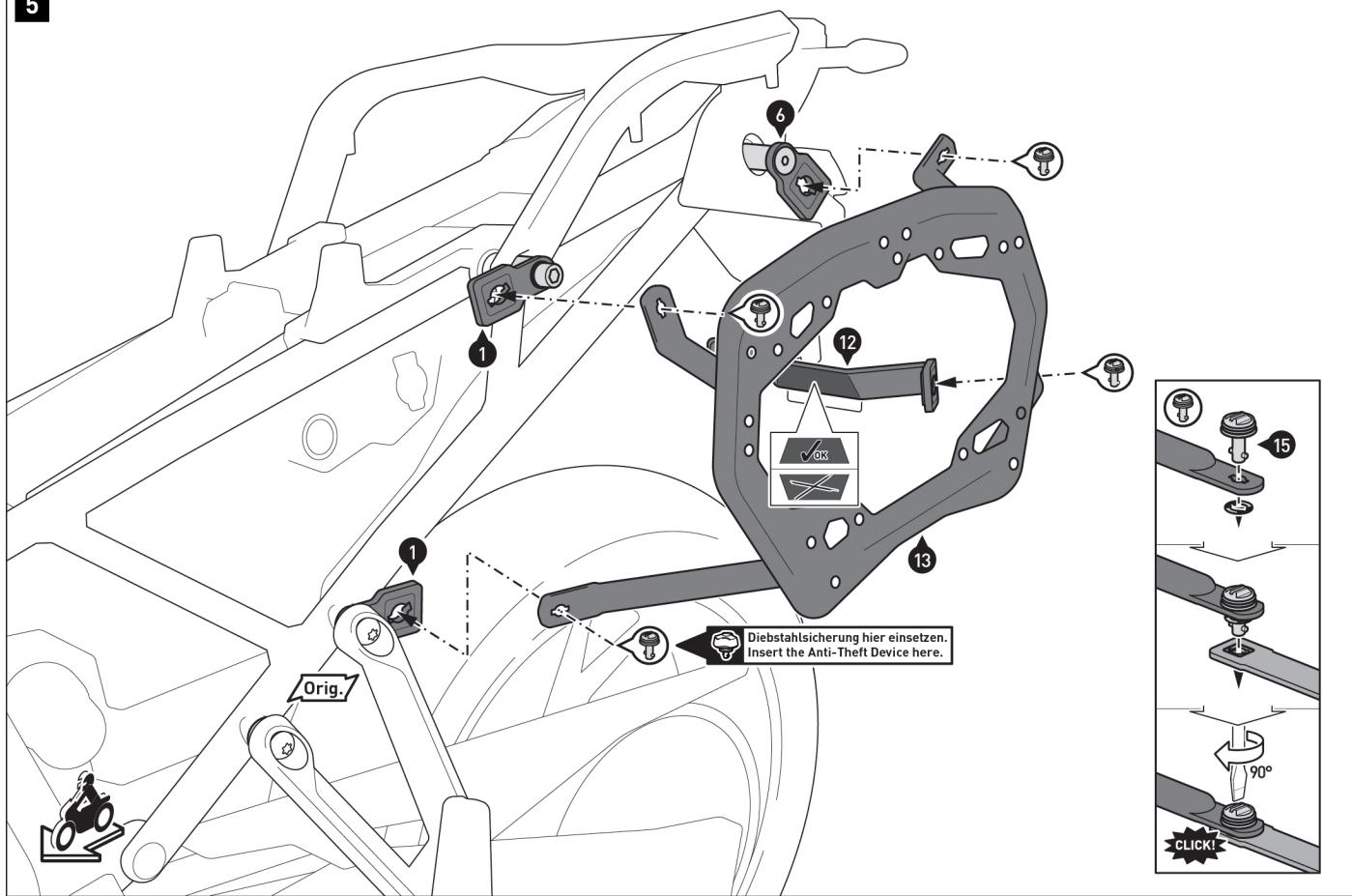
**HINWEIS:** Die SW-MOTECH Diebstahlsicherungen sind separat erhältlich; montieren Sie die Diebstahlsicherungen beidseitig an der markierten Position.
