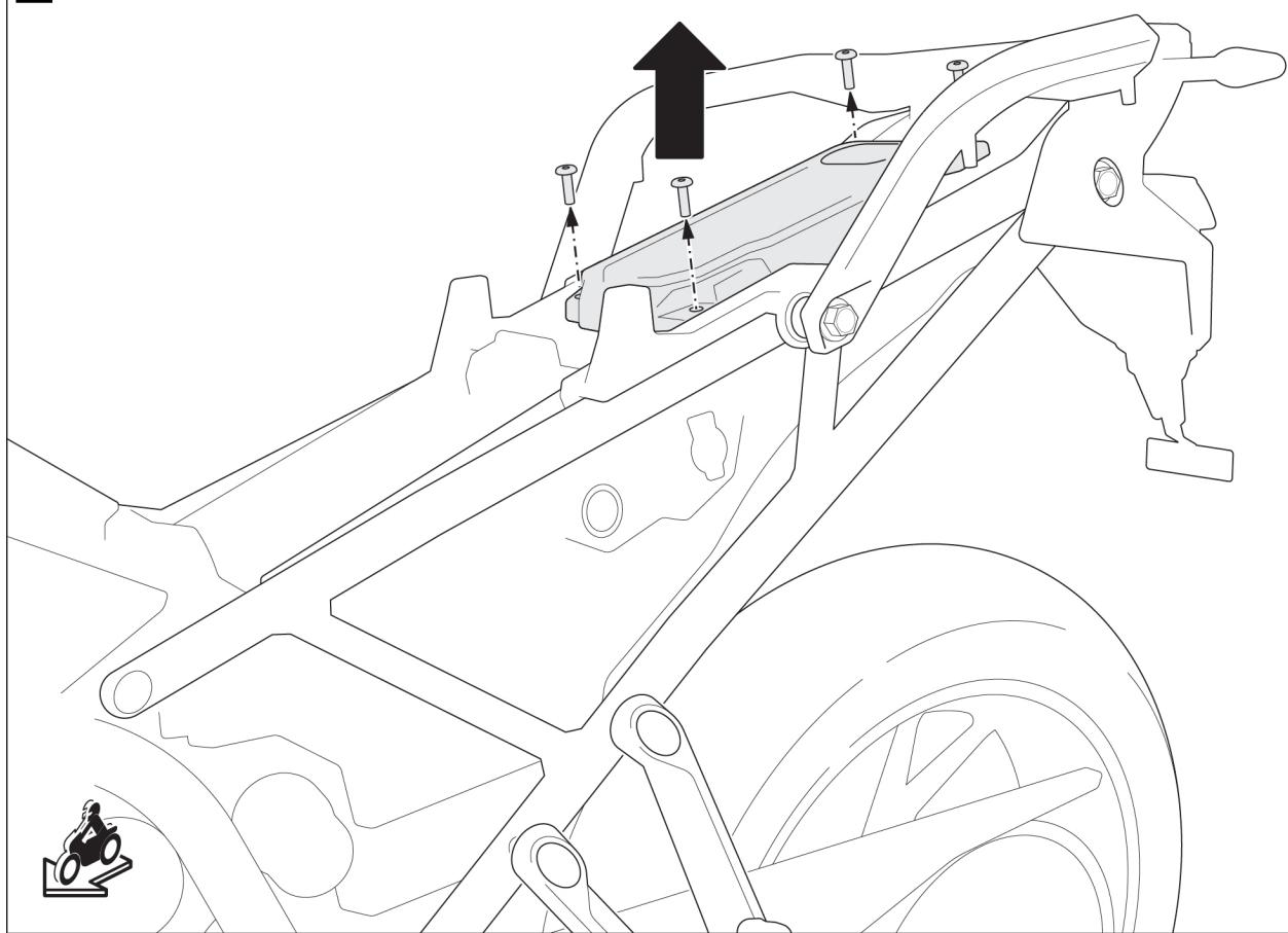
Entfernen Sie die gezeigten Schrauben, lösen Sie den Stecker und entfernen
