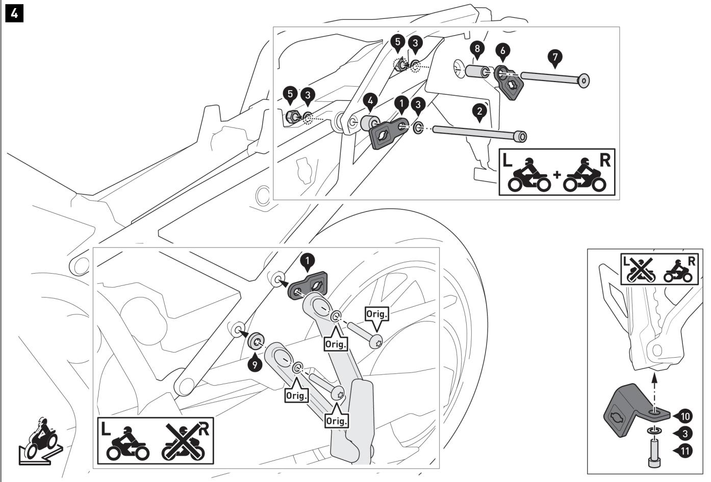
Verschrauben Sie die Befestigungslaschen (1) und (6) beidseitig am Fahrzeug.
