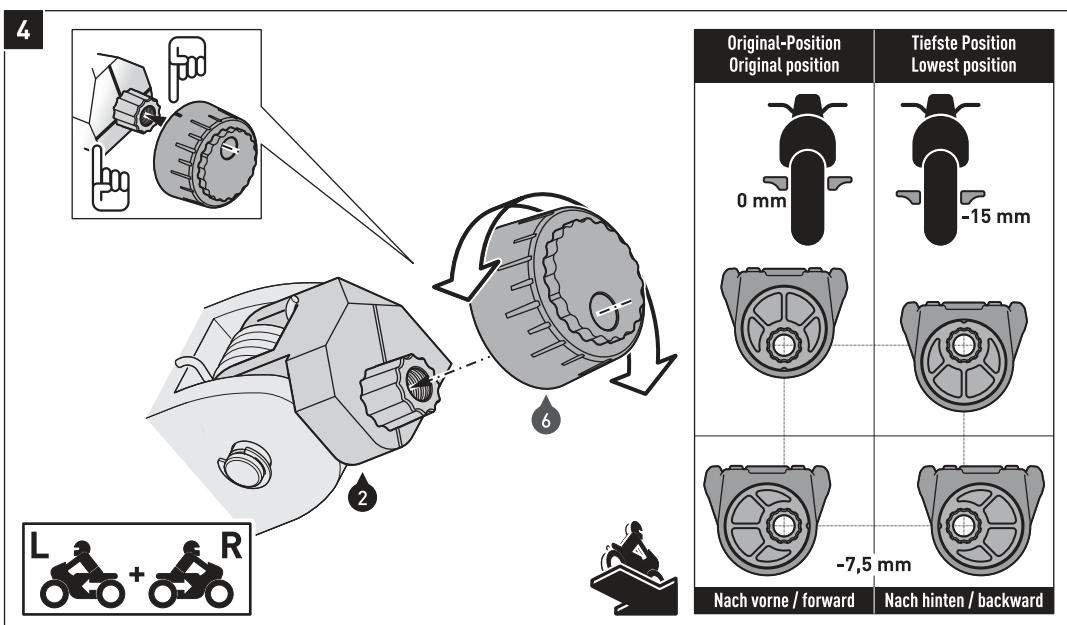
Stecken Sie die Positionierungskonen (6) auf die sternförmigen Aufnahmekonen der Gelenkadapter (2). Durch die verschiedenen Montagepositionen kann die Höhe der Fußrosten (7) individuell angepasst werden (siehe rechte Detailzeichnung).
