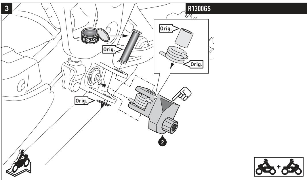
Säubern Sie die Fußrastenaufnahme gründlich. Tragen Sie Schmierfett auf die Bolzen (Orig.) auf. Verbaue Sie die Gelenkadapter (2) mit den original Teilen (Orig.) beidseitig am Fahrzeug. **⚠️ WARENUNG:** Die angeschrägten Flächen der Gelenkadapter (2) müssen nach oben zeigen! **⚠️ WARENUNG:** Sichern Sie die Bolzen (Orig.) mit den original Sicherungselementen (Orig.)!!
