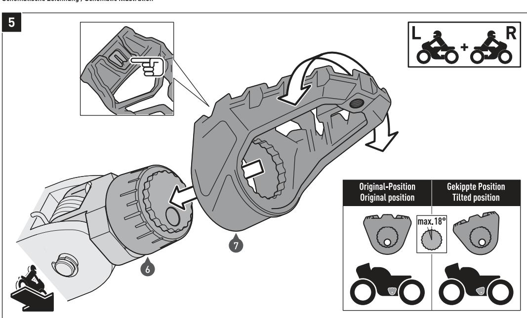
Stecken Sie die Fußrosten (7) auf die Positionierungskonen (6). Durch die Verzahnung der Positionierungskonen (6) kann der Neigungswinkel der Fußrosten (7) individuell angepasst werden (nicht mehr als 18°; siehe rechte Detailzeichnung).
