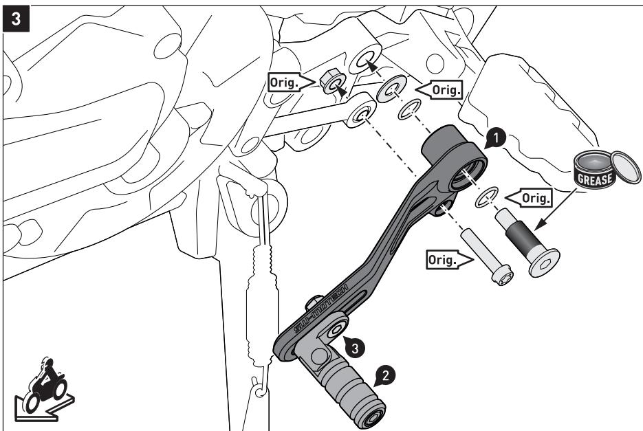
Verschrauben Sie den Schalthebel (1) mit den original Teilen (Orig.) am Fahrzeug.
