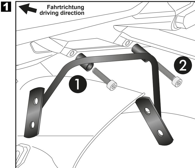
In Kombination mit dem Minirack werden vorne die Zylinderschrauben M6x65 und hinten die Zylinderschrauben M6x75 verwendet.
