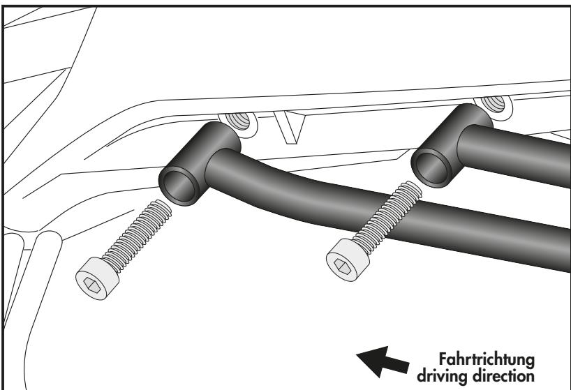
Bei gemeinsamer Montage mit dem C-Bow Halter wird dieser direkt auf den Rohradapttern mit den Linsenkopf-schrauben aus dem C-Bow Schrauben-satz befestigt.
