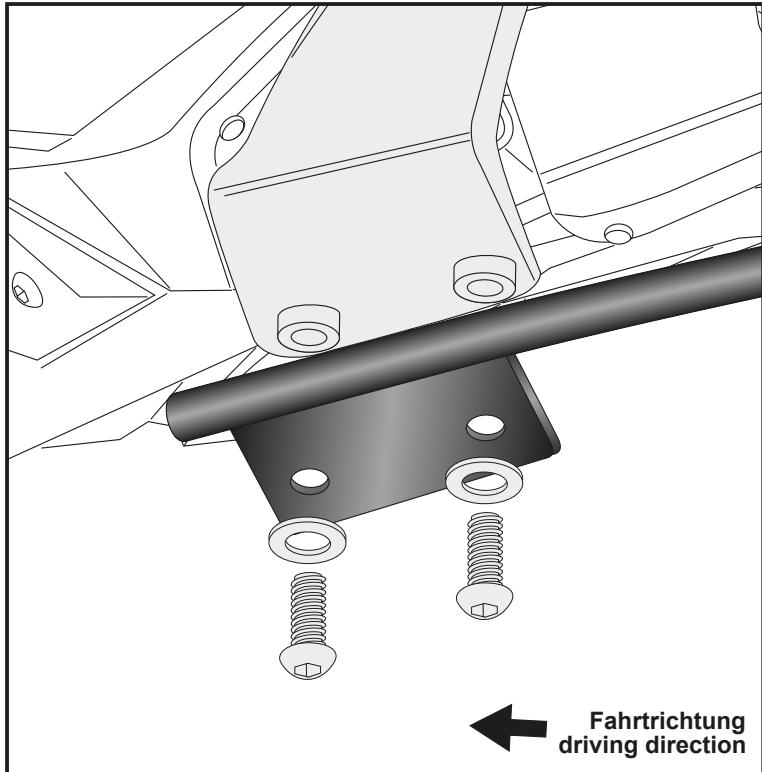
Montage der Rohradapter rechts/links hinten:
