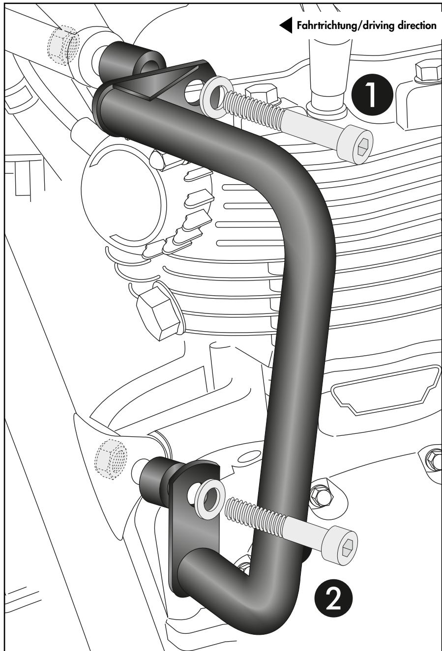
Das Auspuffkrümmerrohr wieder einstecken und mit den originalen Befestigungselementen und nach Herstellerdrehmomentangabe anziehen. Achten Sie darauf, dass Sie die Dichtelemente am Krümmerrohr mit verbauen!
