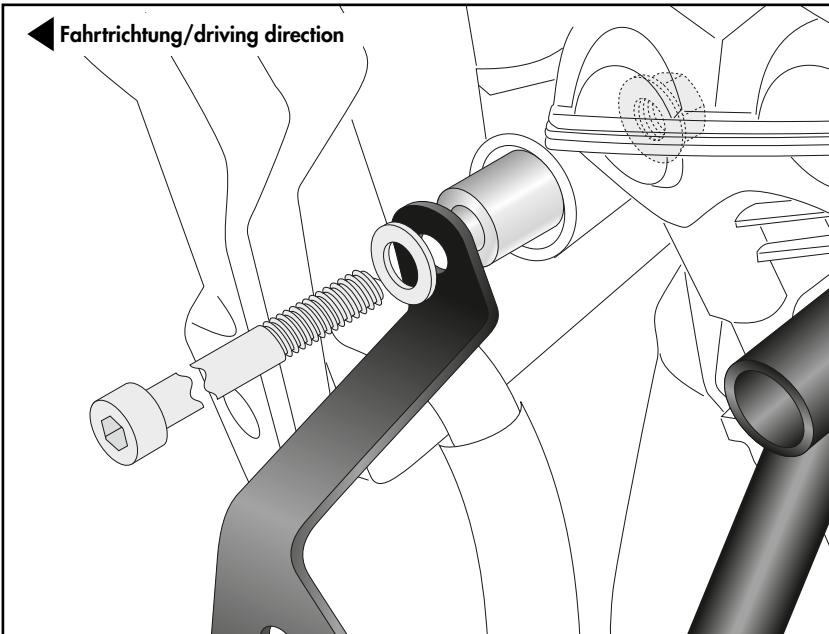
Verbindungsstopfen Ø25mm vorne in das Rohr des linken Schutzbügels einsetzen.
