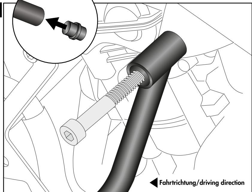
**Montage Motorschutzbügel vorne rechts:**
