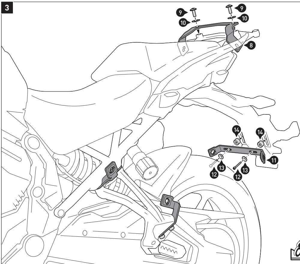
**HINWEIS:** Wenn der Seitenträger mit dem SW-MOTECH Gepäckträger montiert wird, entfallen die Teile (9) & (10). Verwenden Sie stattdessen die Teile des Gepäckträgers.
