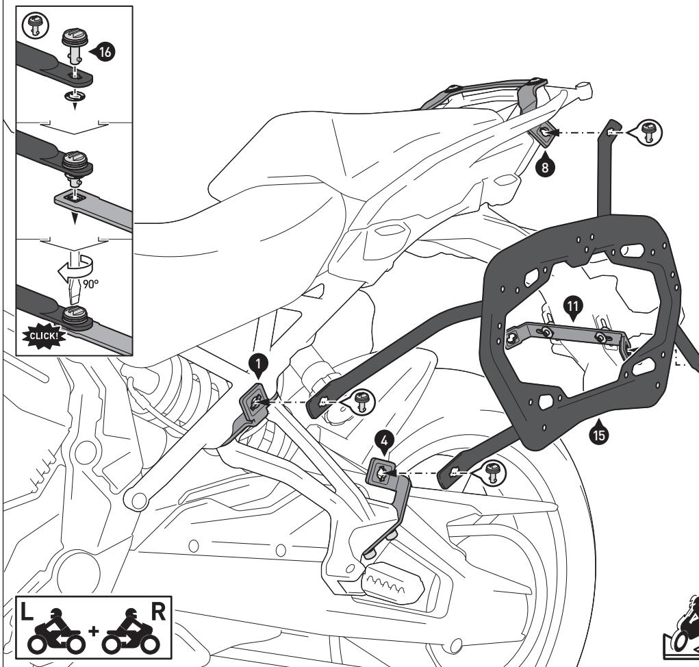
Verbinden Sie die Seitenträger (15) **beidseitig** mit den Schnellverschlüssen (16) an den Befestigungslaschen (1), (4) & (5) und den Querverbindern (8) & (11). Sichern Sie die Schnellverschlüsse (16) mit den Sicherungsscheiben.
