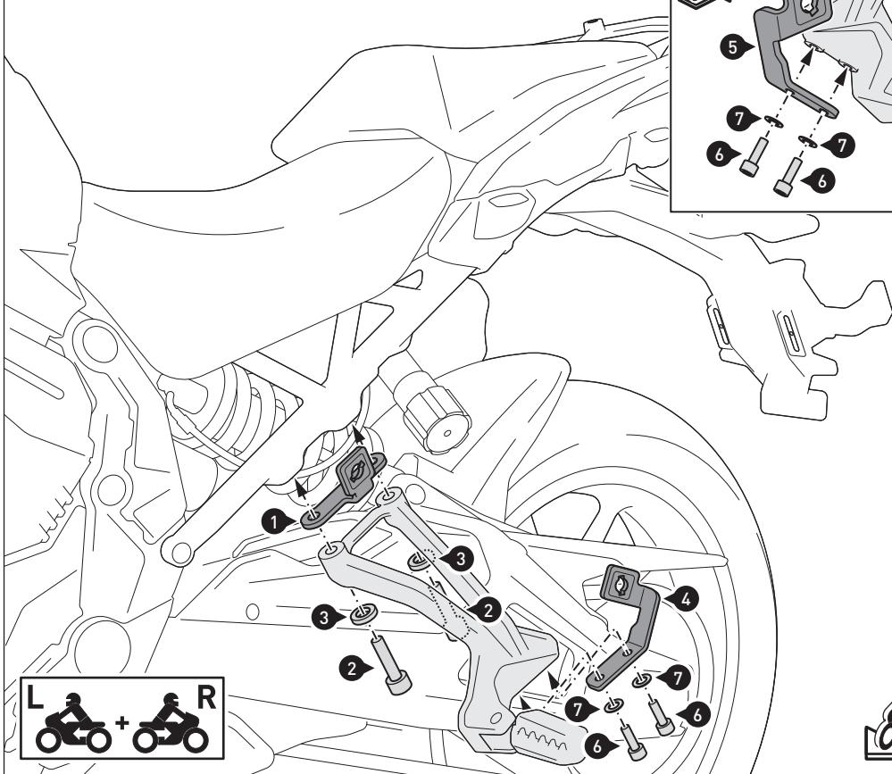
⚠ **HINWEIS:** Die Befestigungs-laschen (4) und (5) sind asymmetrisch aufgebaut. Montieren Sie die Befestigungslasche (5) auf der **linken** Fahrzeugseite, wie in der Detailzeichnung gezeigt.
