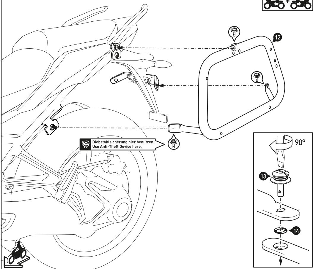
Verbinden Sie die Kofferträger (12) mit den Schnellverschlüssen (13) an den Befestigungslaschen und dem Querverbinder. Sichern Sie die Schnellverschlüsse mit den Sicherungsscheiben (14).
