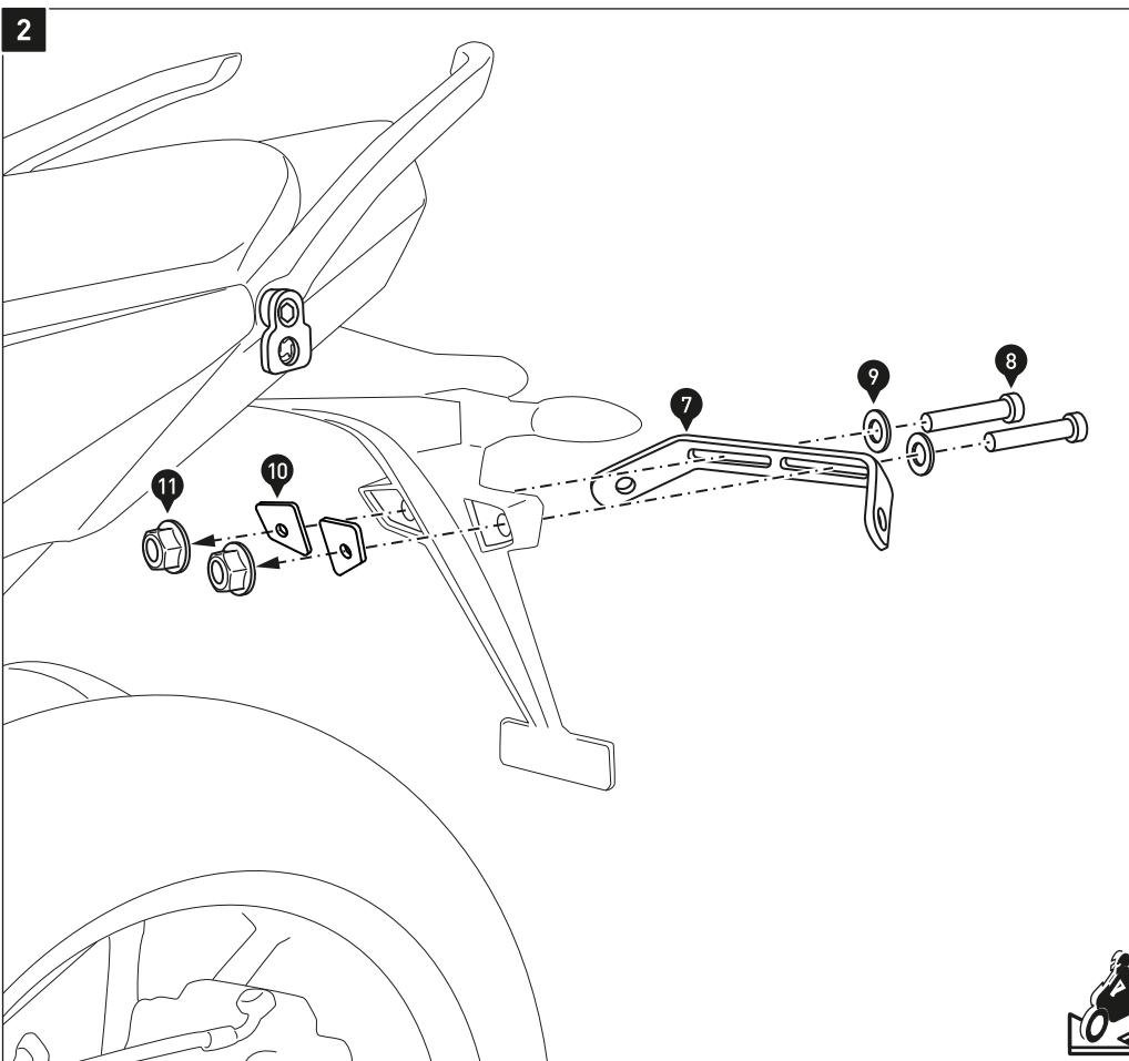
Verschrauben Sie den Querverbin- der (7) am Kotflügel, wie in der Zeichnung gezeigt.
