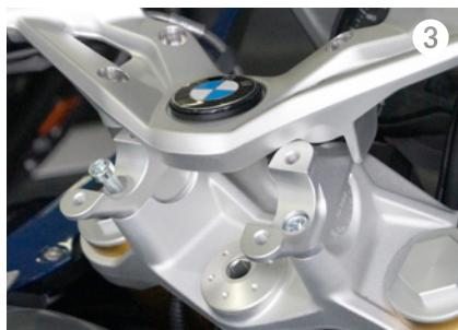
Schrauben M8x30 einsetzen und gleichmäßig festziehen (23Nm)
