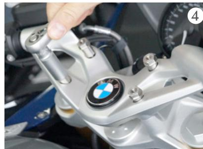
Orig. Schrauben M8 einsetzen und gleichmäßig festziehen (23Nm)
