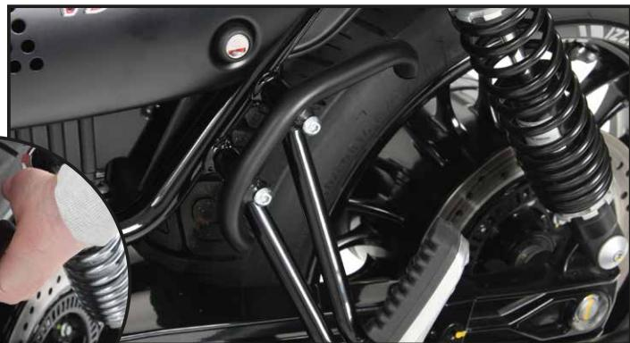
**Alle beweglichen Teile einfetten. Schrauben mit Sicherungsmittel sichern**
