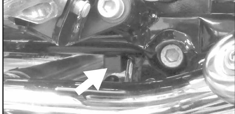
Den Halteadapter so positionieren, dass die vorher eingedrehte Sechskantschraube sich in die freie Bohrung am Rahmen eindrehen lässt.
