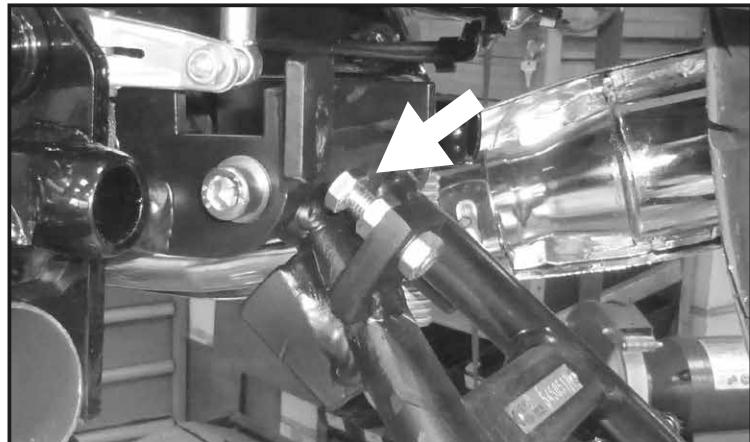
Halteadapter ausrichten und mit der Originalschraube sowie Scheibe und Mutter **locker** anschrauben.
