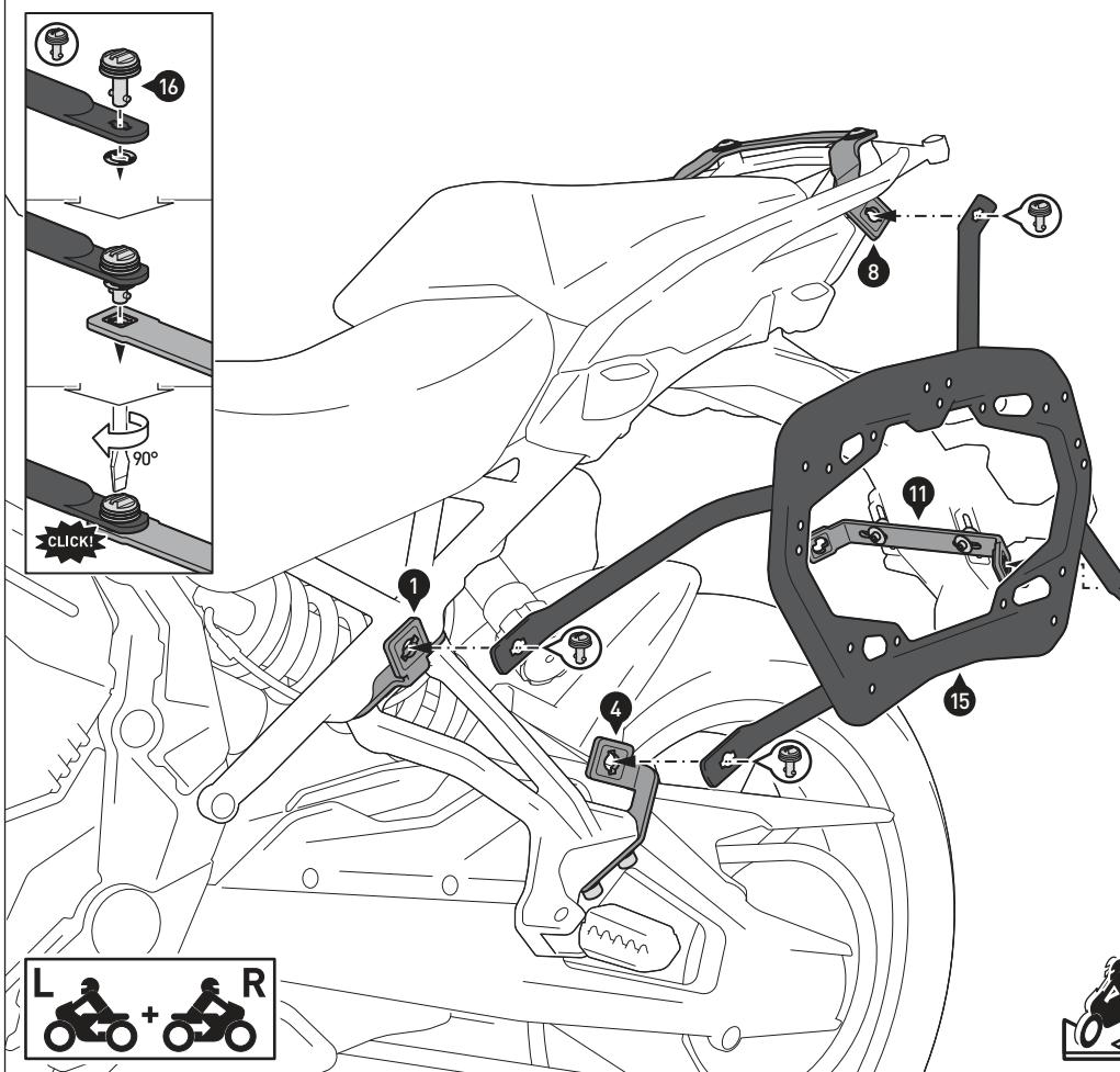
Verbinden Sie die Seitenträger (15) **beidseitig** mit den Schnellverschlüssen (16) an den Befestigungslaschen (1), (4) & (5) und den Querverbindern (8) & (11).
