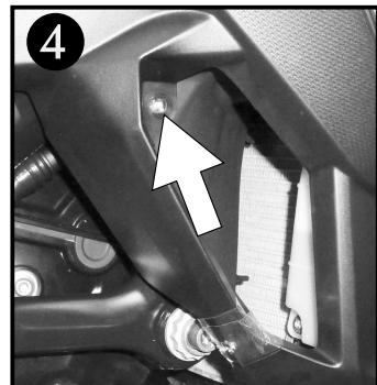
Die Schraubbereiche an der seitlichen Verkleidung mit Klebeband zum Schutz gegen Verkratzen abkleben.
