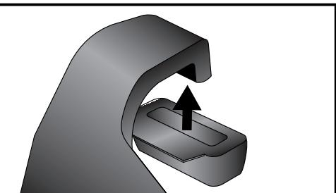
Auf die Einhängelaschen der beiden Kofferträger die Gummipuffer aufschieben. Die Gummipuffer sind nummeriert in Fahrtrichtung gesehen:
