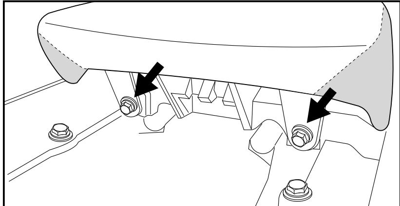
Die beiden markierten Originalschrauben ausdrehen, diese entfallen.
