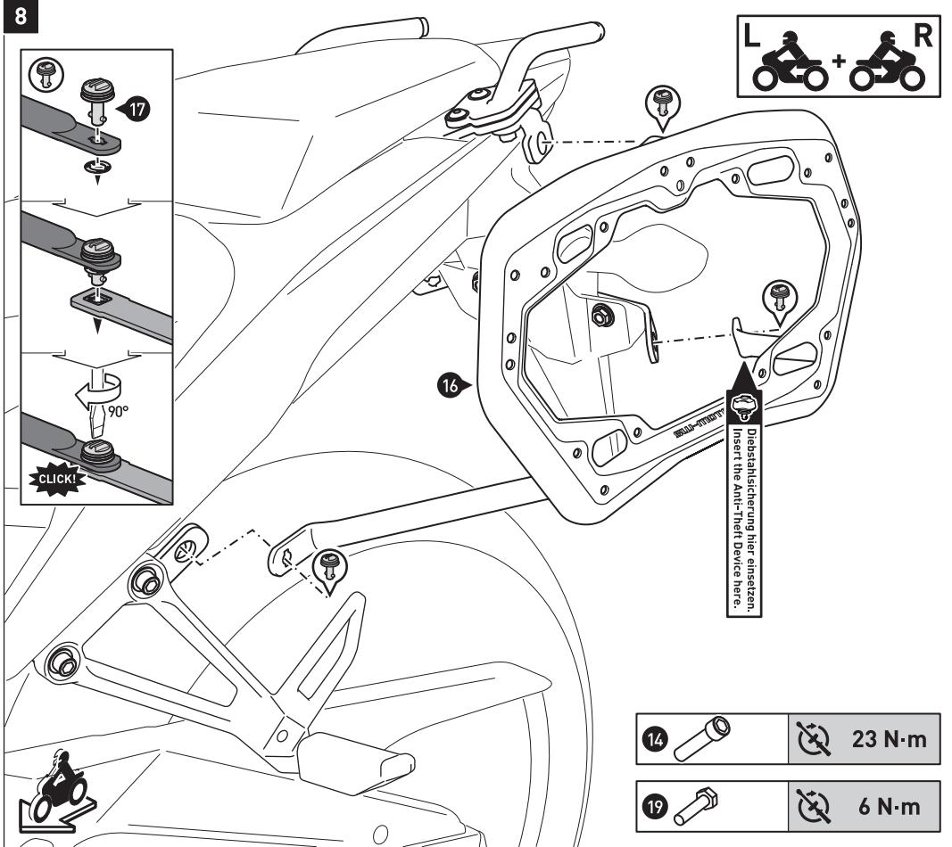
Verbinden Sie die Kofferträger (16) mit den Schnellverschlüssen (17) an den Befestigungslaschen und dem Querverbindner. Sichernen Sie die Schnellverschlüsse (17) mit den Sicherungsscheiben.
