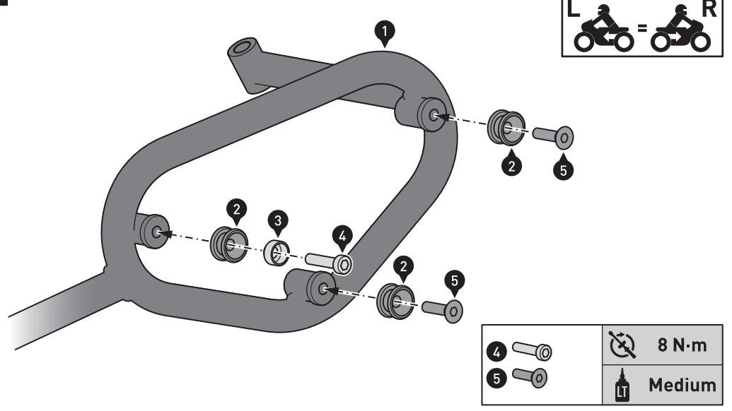
Montieren Sie die Teile (2) bis (5) an den Seitenträgern (1), wie in der Zeichnung gezeigt.
