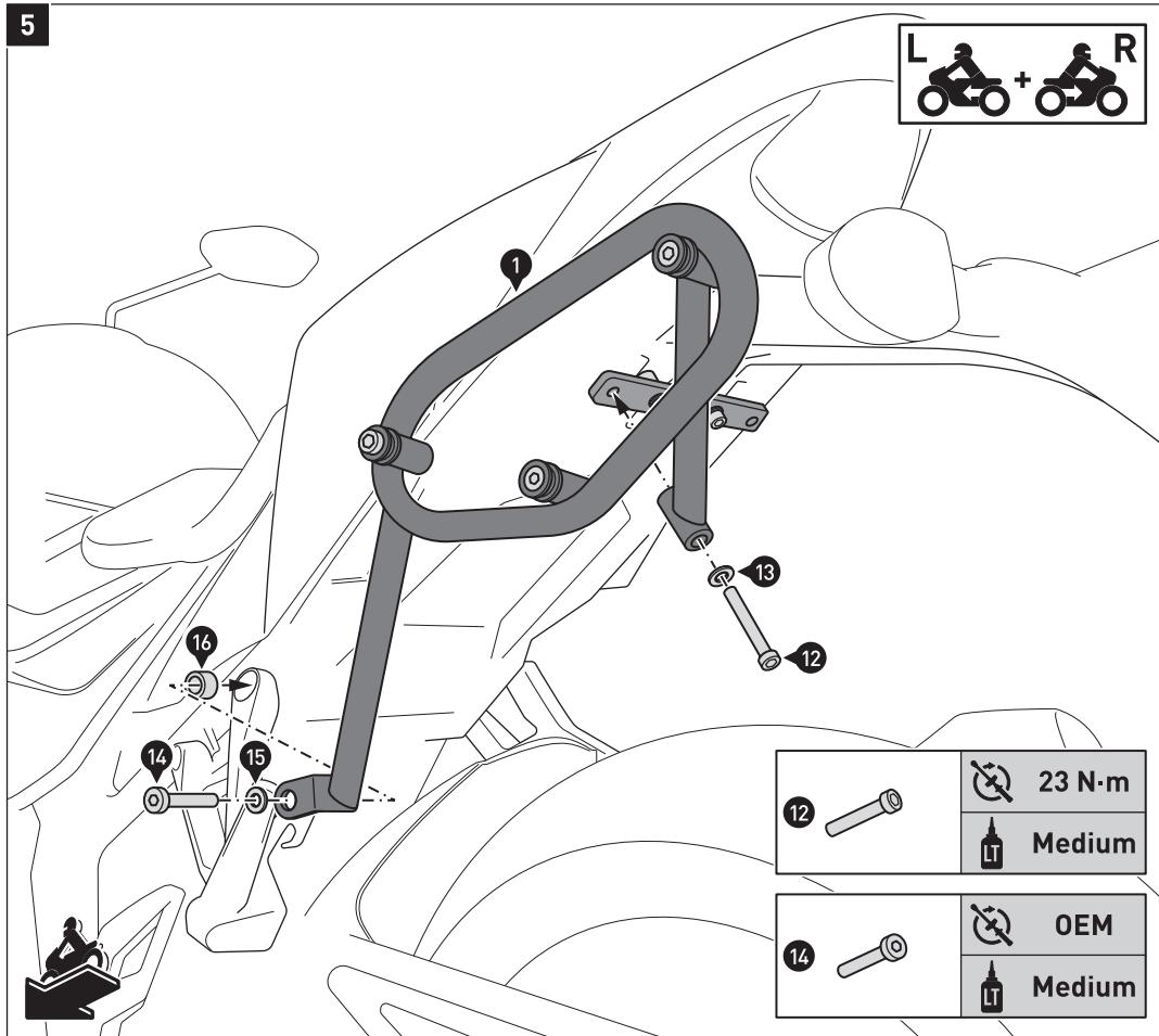
Verschrauben Sie die Seitenträger (1) am Querverbinder (6) und beidseitig an den Fußrastenhalterungen, wie in der Zeichnung gezeigt.
