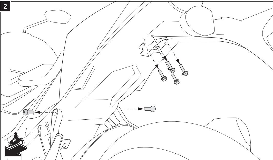
Entfernen Sie die Schrauben vom Fahrzeug, wie in der Zeichnung gezeigt.
