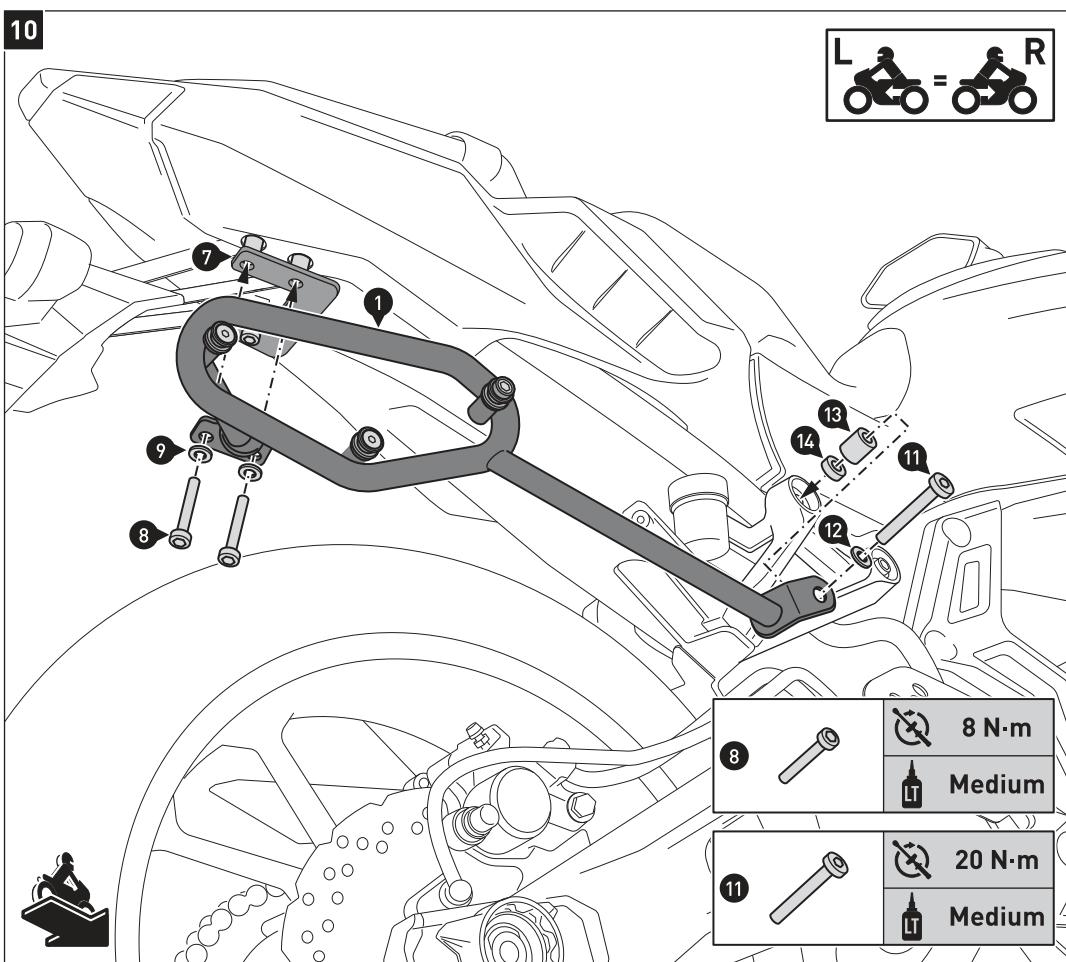
HINWEIS: Bei gleichzeitiger Verwendung des ALU RACK Gepäckträgers entfällt die Distanzbuchse (14).
