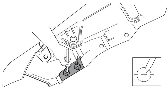
Verschrauben Sie die Seitenverkleidungen mit den in Schritt [5] gezeigten Teilen wieder am Fahrzeug.
