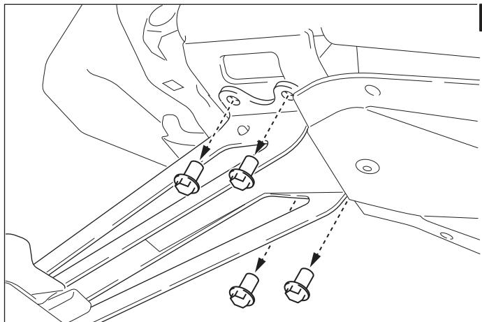
**5** Entfernen Sie die gezeigten Schrauben vom Kotflügel.
