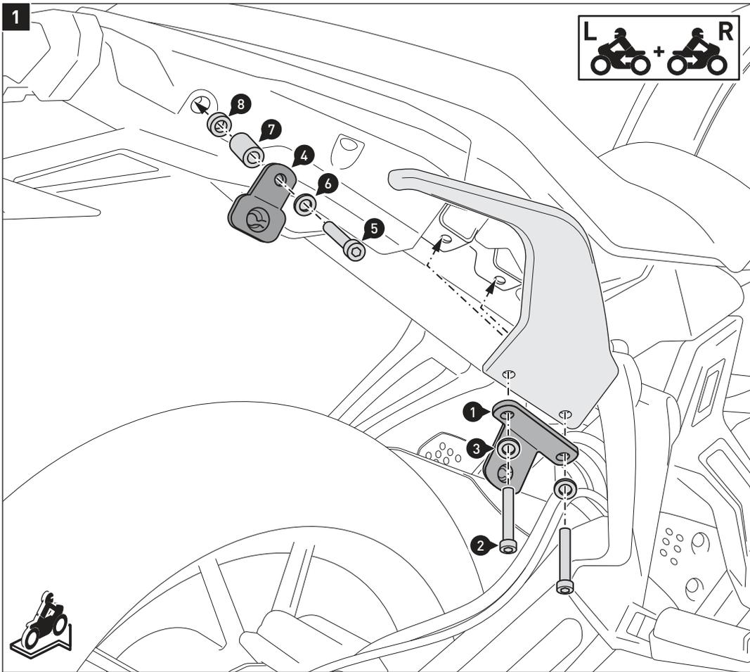
Entfernen Sie die originalen Schrauben von den Anbaupunkten. Verschrauben Sie die Anbaubleche (1) und (4) auf beiden Seiten am Motorrad, wie in der Zeichnung gezeigt.
