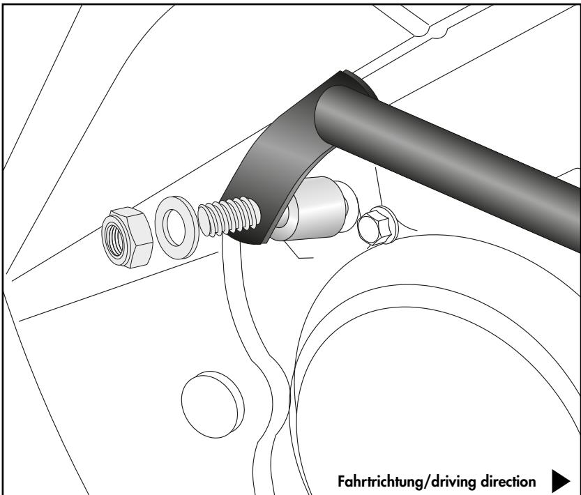
**Montage Motorschutzbügel vorne rechts:**
