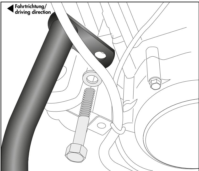
Vorne das Verbindungsstück Ø25 in das Rohrende des Bügels fügen.
