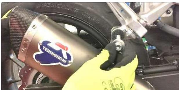
**ITA** Fissare la staffa di supporto al silenziatore usando la vite, rondella e dado originale senza serrare ( per i modelli dal 2019 utilizzare la bielletta, la vite e il dado in dotazione)
