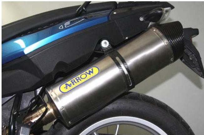
Innestare il silenziatore ARROW sul raccordo originale. Fissare il silenziatore al telaio con la fascetta fornita nel kit di montaggio, quindi assicurarlo al raccordo originale con le molle date nel kit di montaggio.
