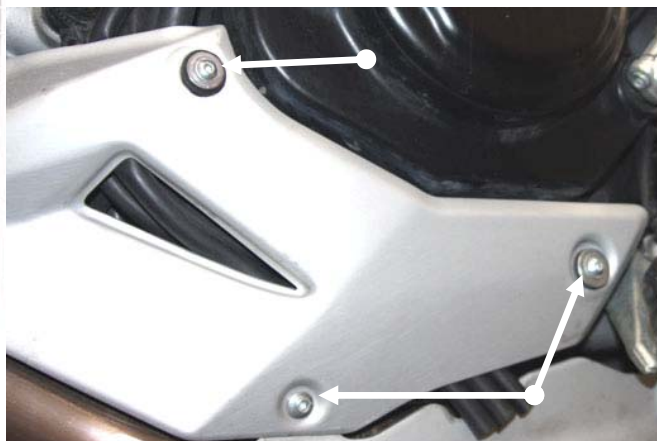
Smontare la protezione del motore Remove engine's cover
