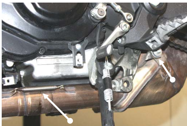
Rimuovere le 2 molle indicate, la vite e sfilare tutto il gruppo scarico originale Remove the springs shown above and remove the whole original exhaust
