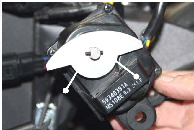
Sostituire il comando originale con l'ingannatore Arrow fornito nel kit di montaggio, avvitare i 2 grani uno per lato (fare attenzione a non stringere i grani oltre i 0.8nm) Replace the pulley with the stainless steel plate given in the fitting kit. Secure it using the two rods given in the fitting kit (warning: maximum torque value for the rods is 0.8Nm)
