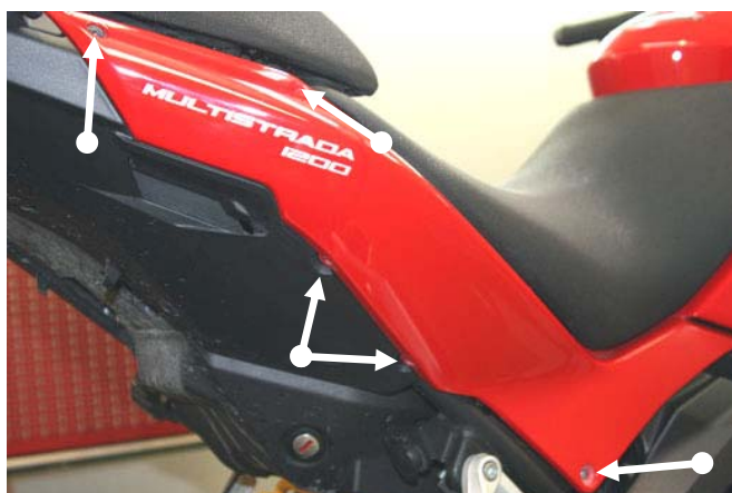
Dopo aver tolto la sella del pilota rimuovere la fiancata laterale destra attraverso le viti indicate Remove the saddle, unscrew the screws showw in the pictures and remove the right side fairing
