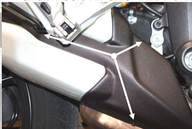
Rimuovere la protezione del terminale Remove OE silencer heat cover
