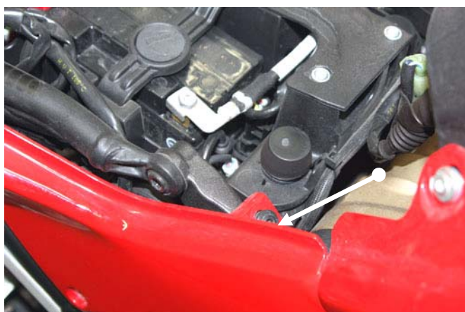
Dopo aver tolto la sella del pilota rimuovere la fiancata laterale destra attraverso le viti indicate Remove the saddle, unscrew the screws showw in the pictures and remove the right side fairing
