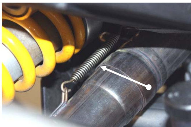
Rimuovere le 2 molle indicate, la vite e sfilare tutto il gruppo scarico originale Remove the springs shown above and remove the whole original exhaust
