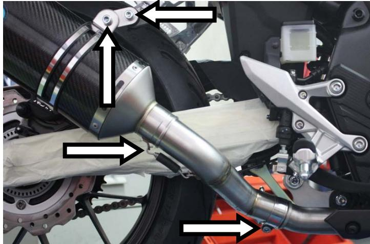
**IT** · Innestare il terminale Race Tech, ancorare la molla, fissarlo alla staffa mediante fascetta di sostegno, serrare la fascetta e la staffa alla pedana
