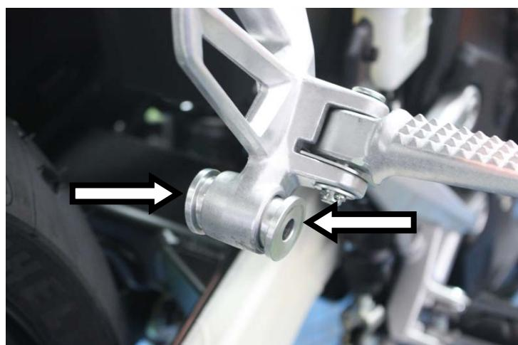
**IT** · Inserire nel foro della pedana passeggero DX i due bussolotti forniti
