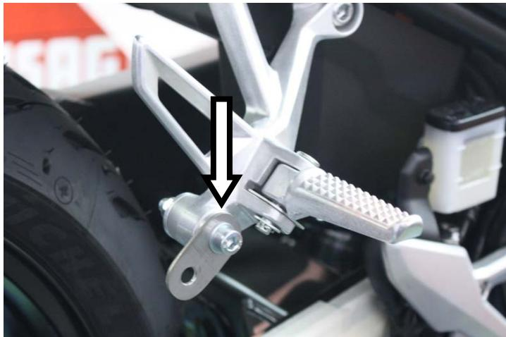
**IT** · Fissare senza serrare completamente la staffa fornita alla pedana passeggero DX
