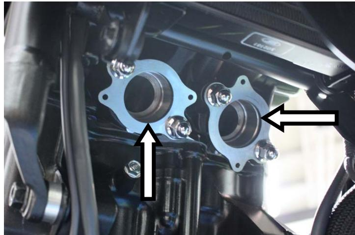
**IT** · Innestare le boccole e fissarle senza serrare completamente mediante le flange ai prigionieri dei cilindri
