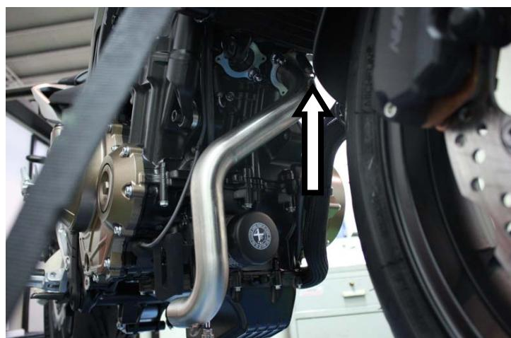
**IT** · Innestare il collettore SX (quello senza saldatura centrale) ed ancorare la molla
