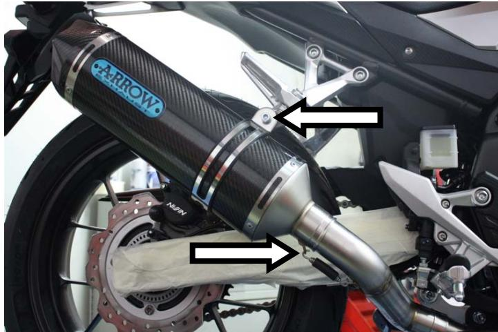
**IT** · Innestare il terminale Race Tech, ancorare la molla e serrarlo alla pedana mediante fascetta di sostegno
