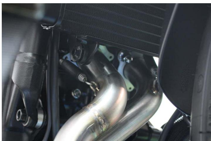
**IT** · Serrare definitivamente i collettori ai cilindri e l'attacco del raggruppamento al telaio
