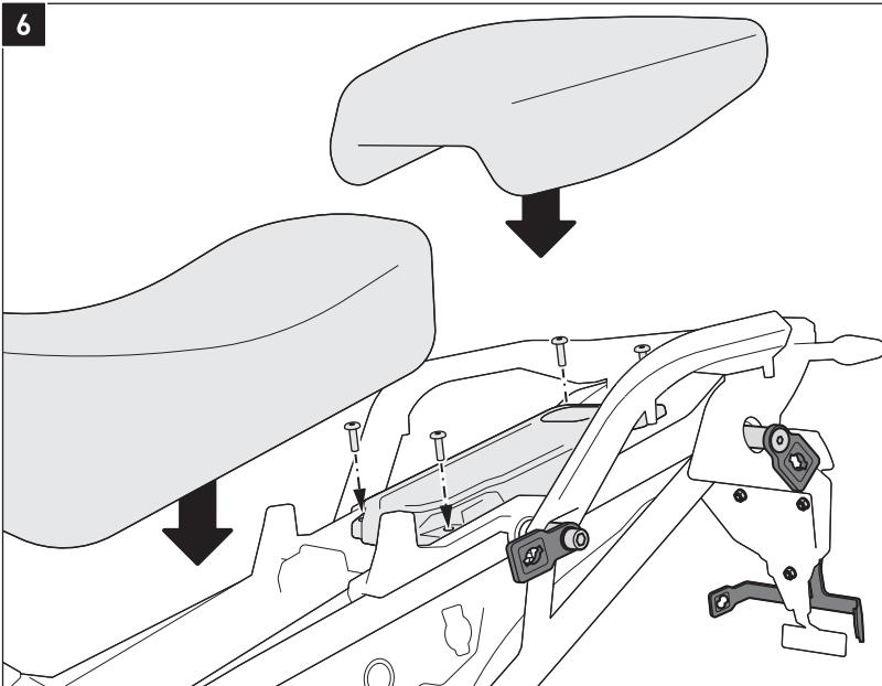
Verbinden Sie das Steuergerät mit dem Bordnetz und verschrauben Sie die Abdeckung am Fahrzeug. Ziehen Sie die original Schrauben [Orig.] nach Herstellerangaben an. Bringen Sie die Sitzbank und den Soziussitz wieder am Fahrzeug an.
