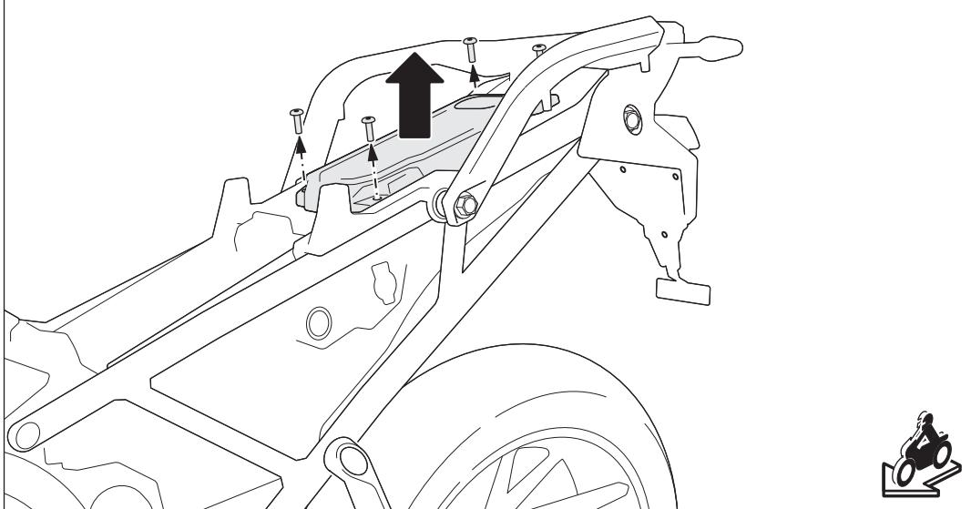
Entfernen Sie die gezeigten Schrauben, lösen Sie den Stecker und entfernen Sie das Steuergerät mit der Abdeckung vom Fahrzeug.
