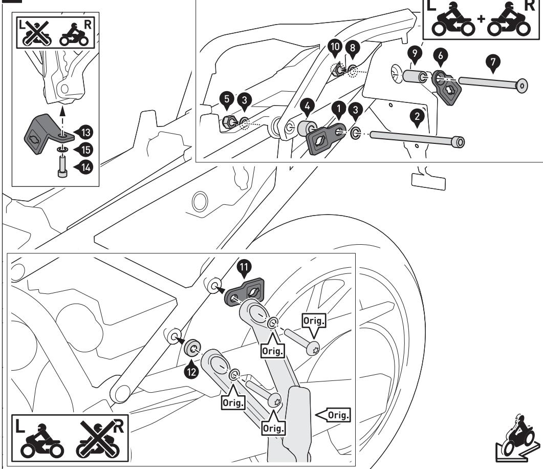
Verschrauben Sie die Befestigungs-laschen (1) und (6) beidseitig am Fahrzeug. Die Befestigungs-lasche (11) wird **links** verschraubt, die Befestigungs-lasche (13) wird **rechts** verschraubt (siehe Detailzeichnung). **ACHTUNG: Verwenden Sie flüssige Schraubensicherung!**
