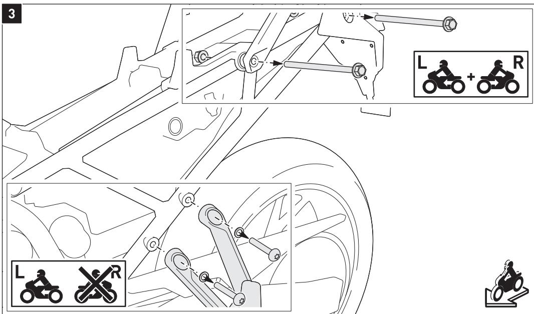
Entfernen Sie die gezeigten Schrauben und Muttern **beidseitig** vom Fahrzeugheck.
