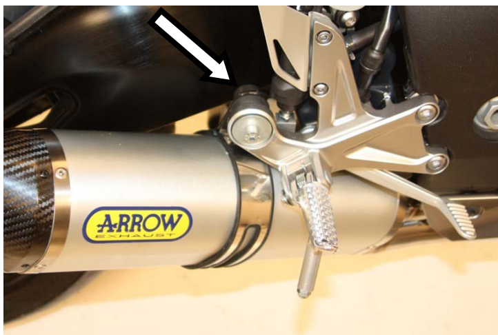
Fissare la fascetta alla pedana Fit the clamp to the footrest
