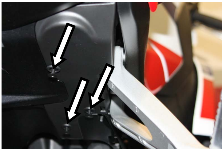
Togliere il coperchio del motore attuatore valvola posto sotto il codone Remove the exhaust valve actuator engine, seated under the tail section
