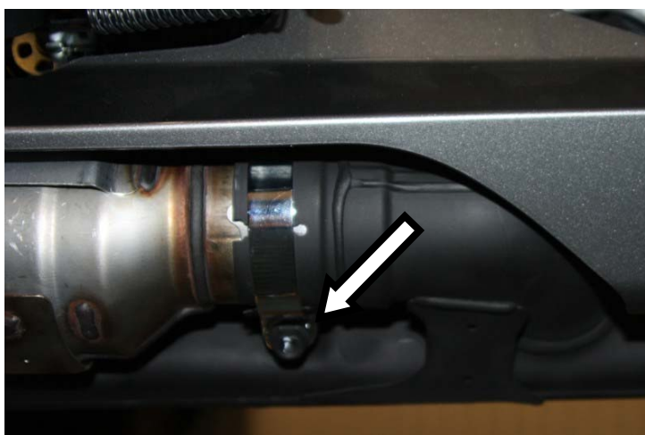
Allentare la fascetta di serraggio del terminale Loosen the ose clip securing the silencer to the mid-pipe
