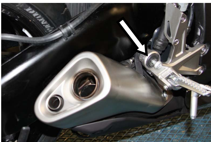
Svitare la vite di fissaggio e rimuovere il terminale Uncrew the screw securing the silencer and remove the silencer
