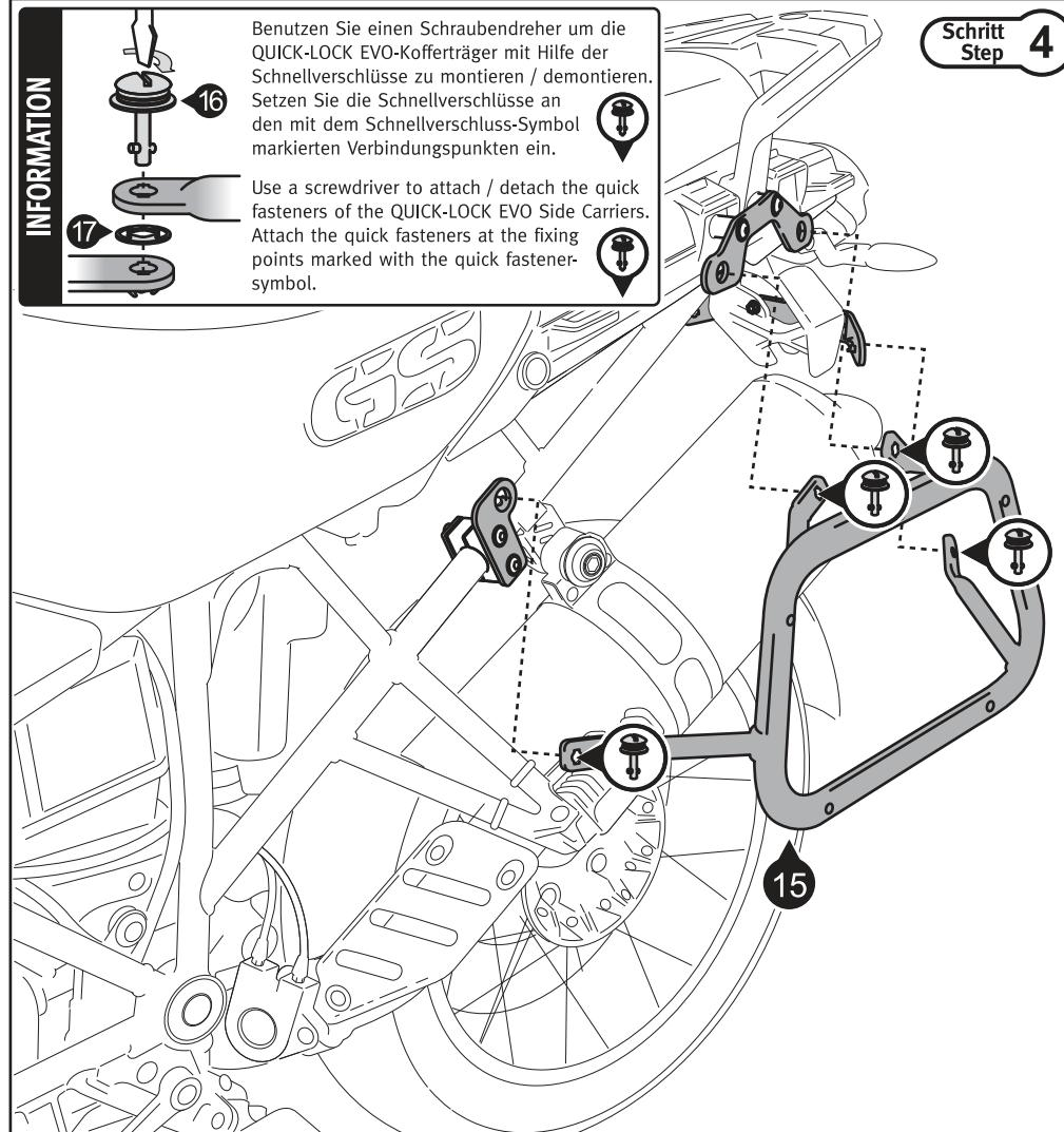
Verbinden Sie die Kofferträger (15) mit Hilfe der Schnellverschlüsse (16) mit den bereits montierten Befestigungsblechen und Querverbinder. **Ziehen Sie abschließend alle Schrauben nach den Vorgaben an:**
