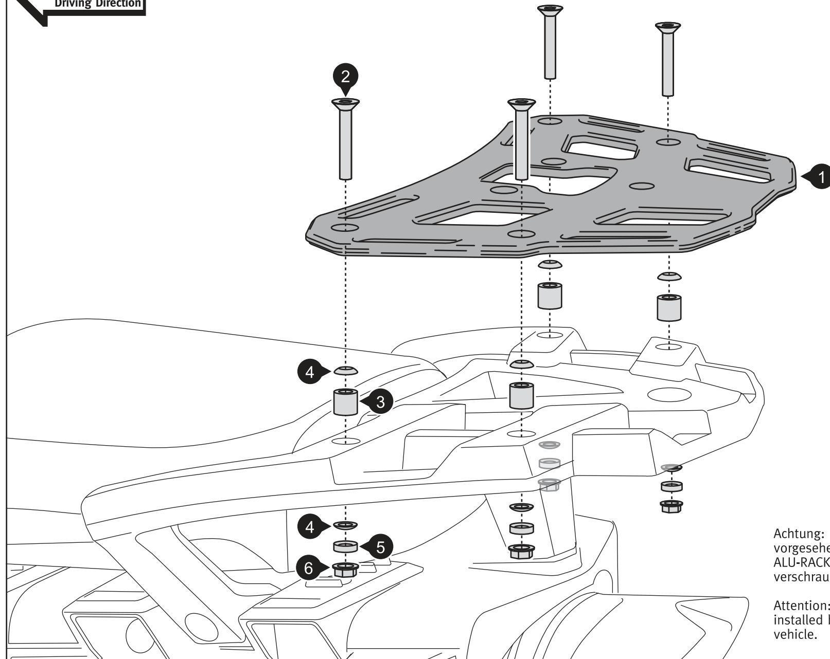
Achtung: Falls die Montage einer Adapterplatte vorgesehen ist, MÜSSEN die Haltenocken am ALU-RACK vor dessen Anbau am Motorrad verschraubt werden.
