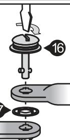
Benutzen Sie einen Schraubendreher um die QUICK-LOCK EVO-Kofferträger mit Hilfe der Schnellverschlüsse zu montieren / demontieren. Setzen Sie die Schnellverschlüsse an den mit dem Schnellverschluss-Symbol markierten Verbindungspunkten ein.
