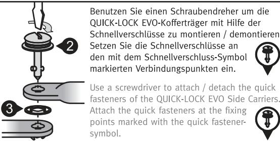
Benutzen Sie einen Schraubendreher um die QUICK-LOCK EVO-Kofferträger mit Hilfe der Schnellverschlüsse zu montieren / demontieren. Setzen Sie die Schnellverschlüsse an den mit dem Schnellverschluss-Symbol markierten Verbindungspunkten ein.
