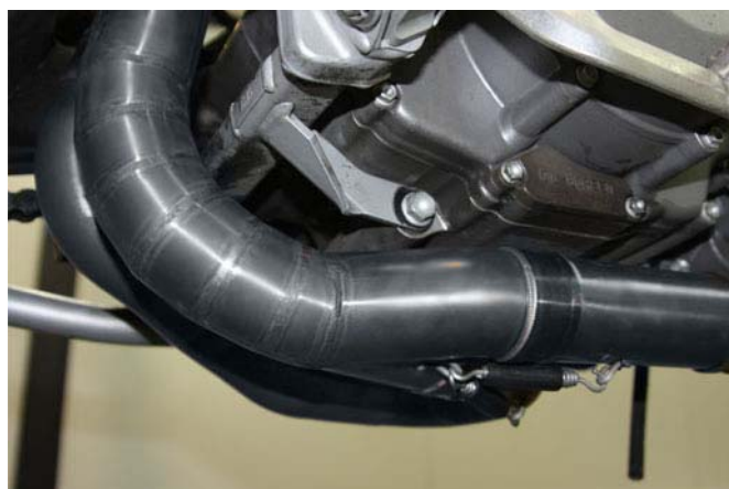
Preassemblare il collettore secondario posteriore al raccordo centrale e innestarlo nel collettore, avvitare poi la sonda lambda Fit rear collector to the mid-pipe and secure the spring then fit it to the rear header. Plug the oxygen sensor
