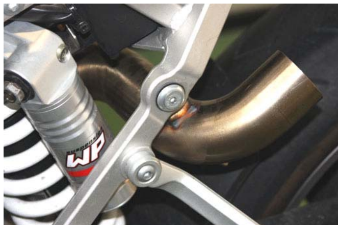
Agganciare il raccordo al telaio con la bulloneria originale Secure the mid-pipe to the frame using original hardware
