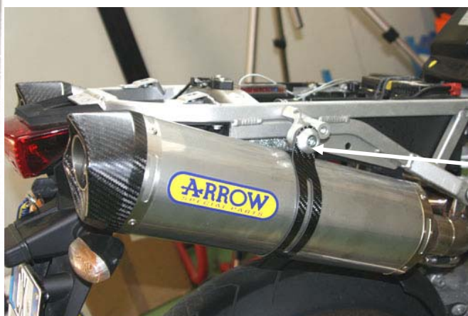
Montare i terminali Arrow e fissarli al telaio con la bulloneria Arrow e fissarlo con le molle Fit arrow silencer, secure them to the frame using the clamp and hardware given in the fitting kit. Secure the springs
