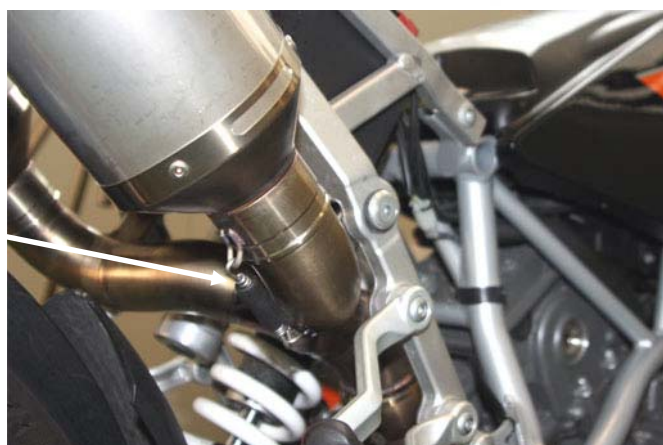
Montare i terminali Arrow e fissarli al telaio con la bulloneria Arrow e fissarlo con le molle Fit arrow silencer, secure them to the frame using the clamp and hardware given in the fitting kit. Secure the springs
