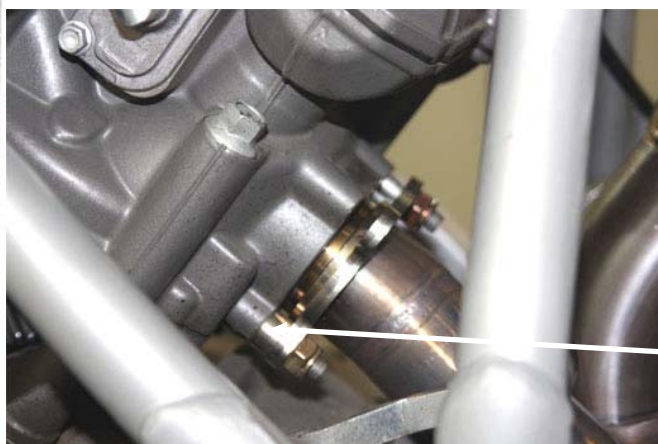
Innestare il collettore posteriore al cilindro senza stringerlo (controllare la presenza della guarnizione originale dentro il cilindro, rimontare lo spessore della flangia nella stessa posizione dell'originale) Fit Arrow rear header and do not tighten it (check the gaslet to be properly positioned on the cylinder, fit the flange spacers as shown in picture above)
