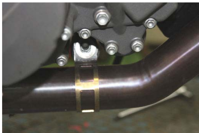
Agganciare la fascetta di serraggio fornita nel kit Arrow Fit Arrow clamp given in the fitting kit as shown in picture
