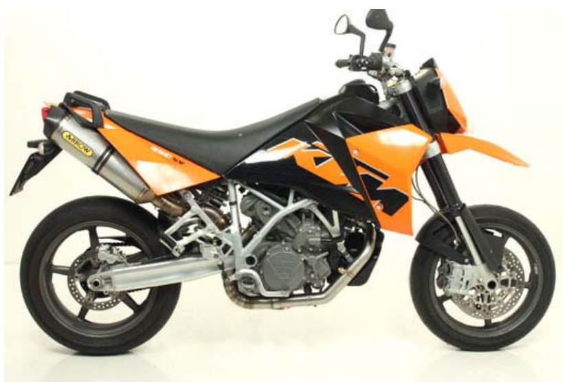
Montare i terminali Arrow e fissarli al telaio con la bulloneria Arrow e fissarlo con le molle Fit arrow silencer, secure them to the frame using the clamp and hardware given in the fitting kit. Secure the springs
