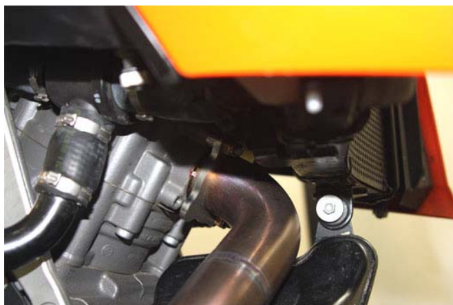
Montare il collettore anteriore e fissare il tutto (controllare la presenza della guarnizione originale dentro il cilindro, rimontare lo spessore della flangia nella stessa posizione dell'originale) Fit Arrow front collector and secure it (check the gaslet to be properly positioned on the cylinder, fit the flange spacers as shown in picture above)
