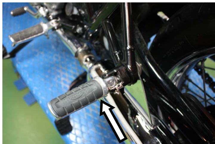
Sfilare il perno e rimuovere il pedalino Remove the pin and remove the footrest
