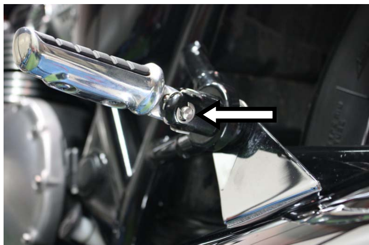
Togliere l'anello elastico dal perno del pedalino passeggero SX Remove the circlip from the LH passenger's footrest pin
