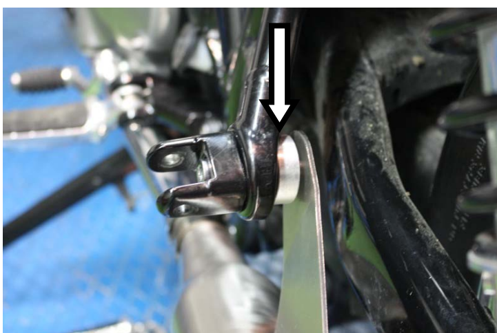
Innestare il terminale e serrare l'attacco alla pedana interponendo lo spessore fornito Fit the silencer and secure the mount to the footrest, using the spacer given in the fitting kit
