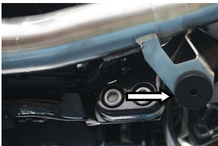
Inserire il gommino battuta cavalletto fornito nell'attacco del collettore SX Fit the rubber stand-upstop to the mount welded to LH collector
