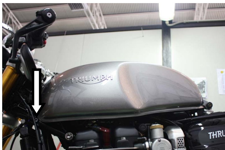
Arretrare il serbatoio verso il posteriore ed allentare la vite indicata Move the fuel tank backwards and loosen the screw shown above
