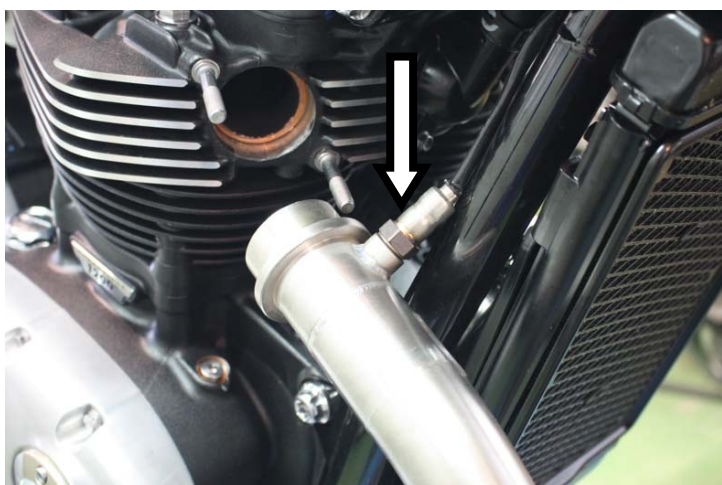
Avvitare la lambda nel collettore DX Plug oxygen sensor to RH collector
