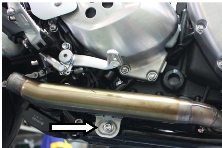
Svitare la vite indicata e rimuovere il raccordo DX Remove the screw shown above and remove RH link pipe
