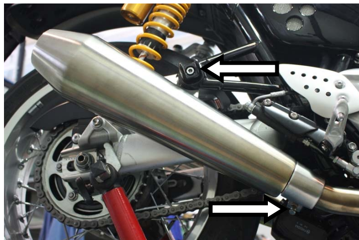
Allentare la fascette, svitare le viti di fissaggio e rimuovere i terminali DX ed SX Loosen hose clips, remove the screws and remove RH and LH OE silencers
