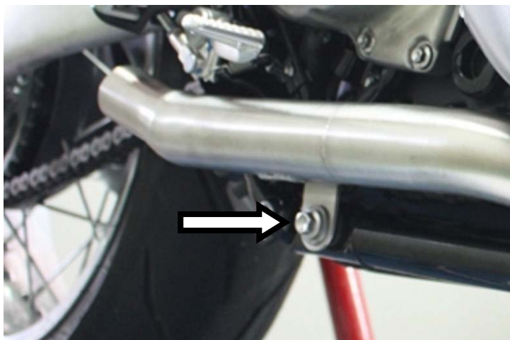
Serrare senza stringere completamente l'attacco al telaio mediante bulloneria originale Secure the welded mount to the frame using OE hardware (do NOT tighten in this phase)
