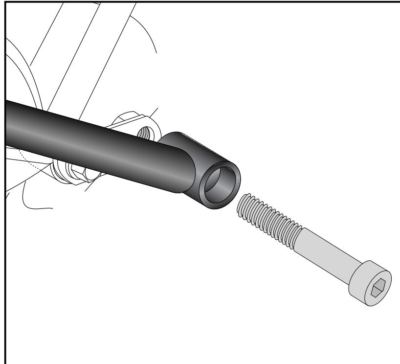
Montage der Tankschutzbügel vorne:
