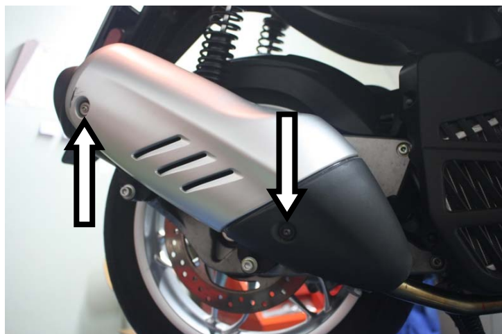
Svitare le viti indicate (2) e rimuovere la protezione Unscrew the screws shown above and remove OE cover
