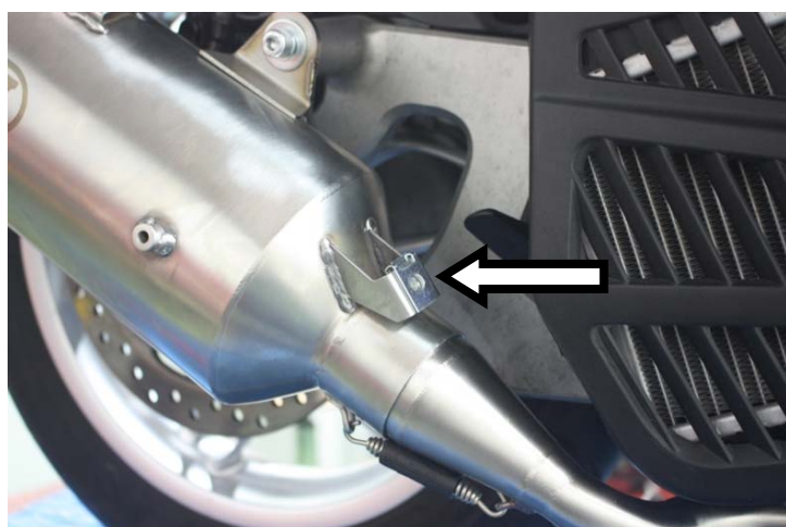
Inserire la clip nell'attacco anteriore del terminale Fit the caged nut to silencer front mount
