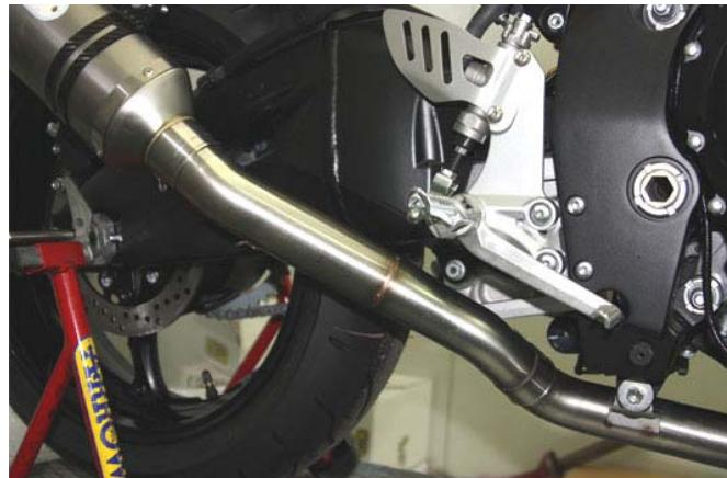
Innestare il raccordo terminale nel silenziatore, poi montare il tutto nel raccordo centrale
