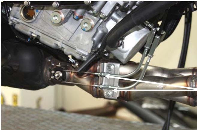
Procedere ora con la rimozione dei cavi per il comando della valvola, allentare i dadi per la regolazione del cavo ed estrarre i fili in metallo
