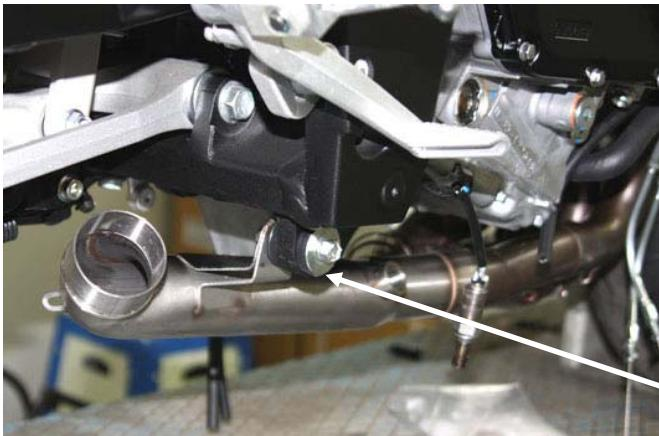
Inserire tutto il gruppo raggruppamenti e raccordo nei collettori, agganciare il raccordo nell'attacco al telaio, avvitare la sonda lambda e fissare il tutto con le molle fornite nel kit
