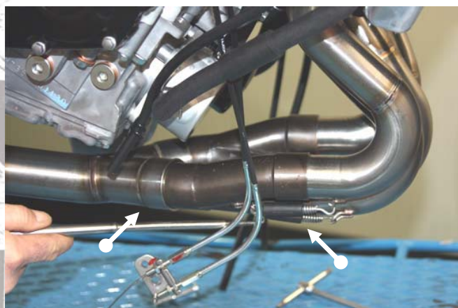
Inserire i raggruppamenti e il raccordo nei collettori e fissare il tutto con le molle Fit 2:1 manifolds and 2:1 mid-pipe to the collectors and secure them with the springs
