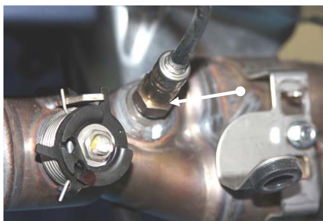
Svitare la sonda lambda Unplug the oxygen sensor
