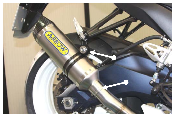
Montare il silenziatore con la fascetta di sostegno in dotazione e la bulloneria originale. Fissare il terminale al raccordo con la molla in dotazione Fit the silencer to the mid-pipe, using original hardware and the clamp given in the fitting kit. Secure the spring between the mid-pipe and the silencer
