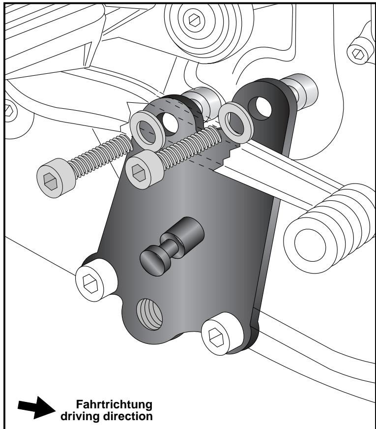
Auf der linken Seite die beiden Schrauben des Seitenständers lösen und diesen demontieren. Die beiden Originalschrauben darunter entfernen, diese entfallen.
