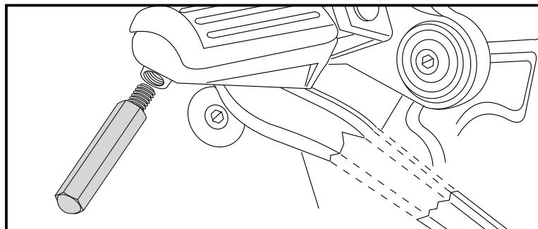
In die beiden Halter jeweils in die äußeren Gewindebohrungen die Zylinderschrauben M10x12 eindrehen.
