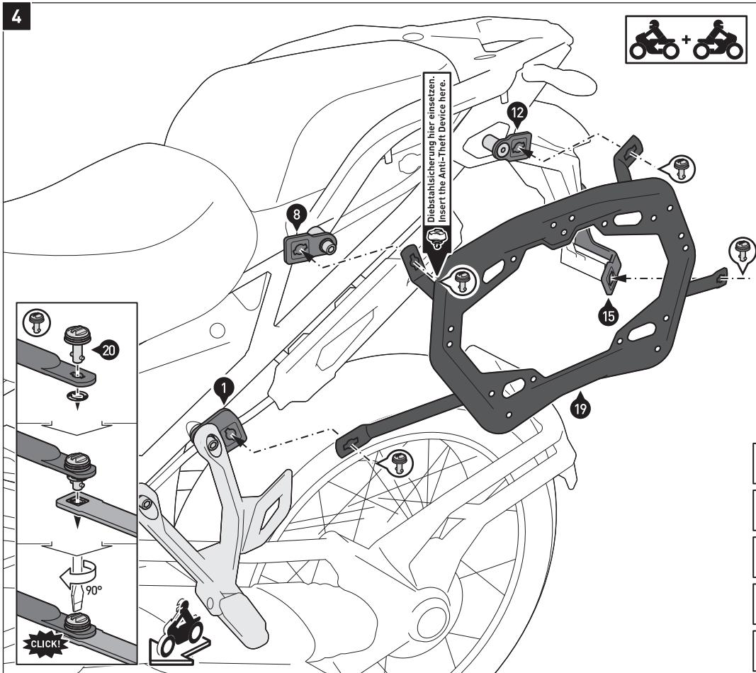
Verbinden Sie die Seitenträger (19) mit den Schnellverschlüssen (20) an den Befestigungslaschen (1), (4), (8) und (12) und dem Querverbinnder (15). Sichern Sie die Schnellverschlüsse mit den Sicherungsscheiben.
